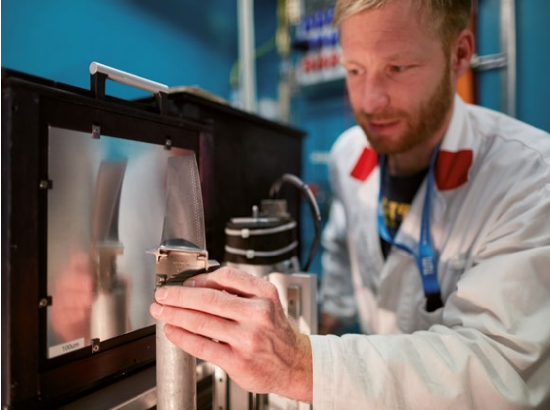
Dr. Michael Schulz erzeugt an der Radiografie- und Tomografieanlage ANTARES Bilder aus dem Inneren von Metallen.
