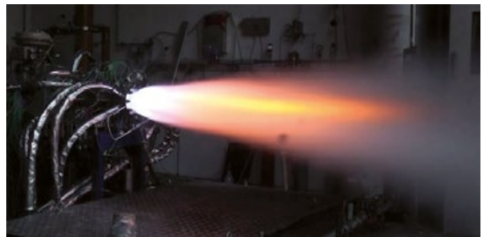
Brennkammer- und Düsentest eines Wasserstoff-Sauerstoffgemischs
