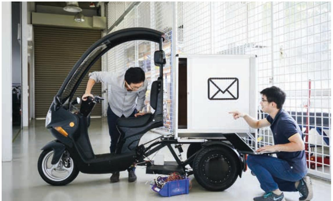
So soll der batteriebetriebene Post-Roller aussehen, der in Zukunft für die schadstoffarme Zustellung von Briefen und Paketen eingesetzt werden könnte.
