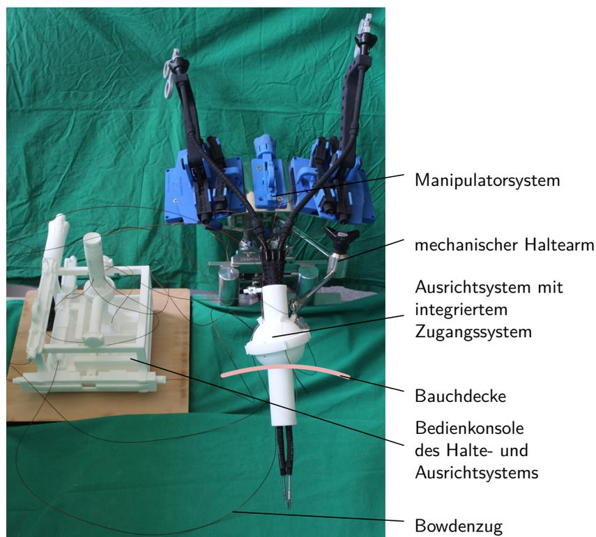
Abb. 6.17: Halte- und Ausrichtsystem (weiß) zur Ausrichtung des Manipulatorsystems (schwarz) (nach Horn, 2020, S. 57).
