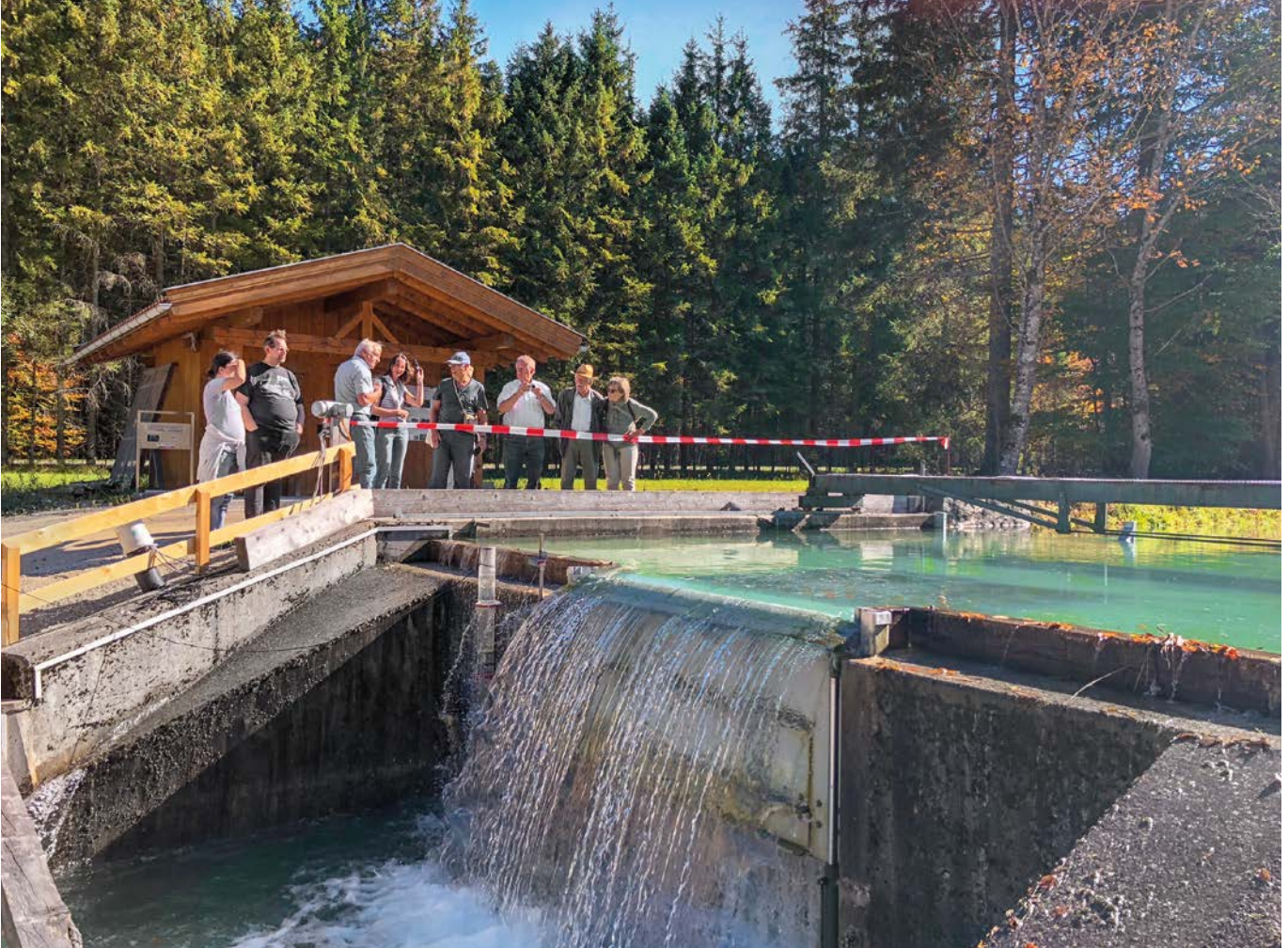
TUM-Angehörige, Touristen, Alumni, Ausflügler und Gäste aus den Nachbardörfern informierten sich in der Versuchsanstalt Oberrach für Wasserbau und Wasserwirtschaft. Besonders spektakulär: die Versuche im 1:1-Maßstab mit großen Abflüssen im Freigelände; hier ein Schachtkraftwerk. © Versuchsanstalt für Wasserbau und Wasserwirtschaft
