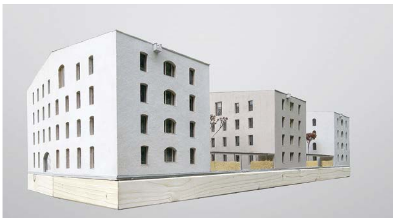
Modell der drei Wohnhäuser aus Mauerwerk, Massivholz und Leichtbeton. © Florian Nagler Architekten
