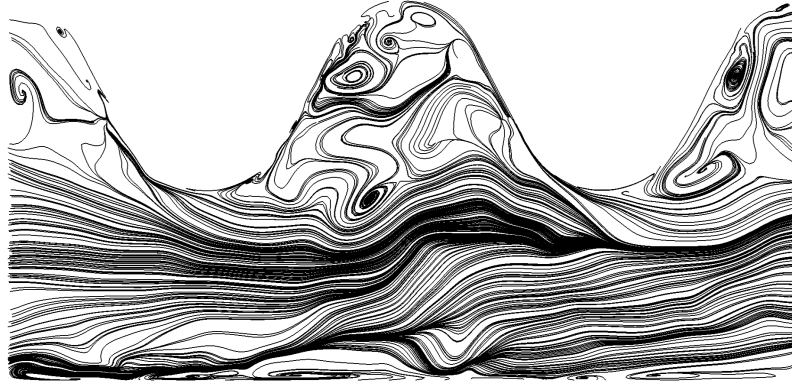
Abbildung 8.13: Stromlinien in einem um 45^\circ zur Horizontalen geneigten Schnitt zur Visualisierung der ungeordneten Wirbelstrukturen in der Gasphase
