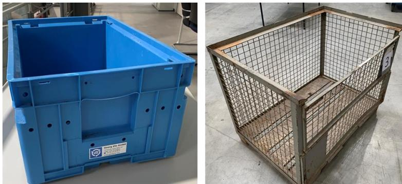
Abbildung 2-1: Standardisierte Ladungsträger, KLT (links) und Euro-Gitterbox (rechts)
