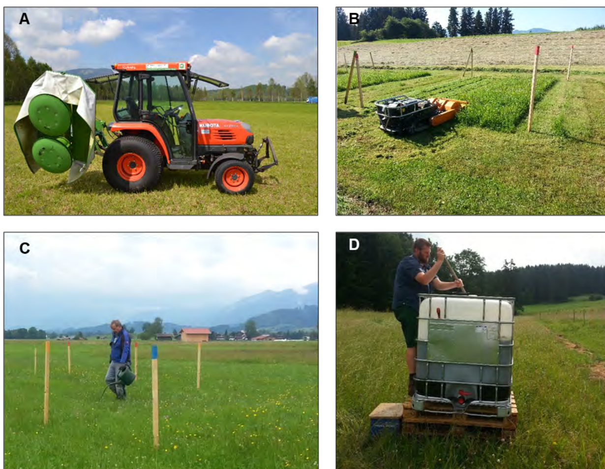
Abb. 20: Zur Versuchsbewirtschaftung eingesetzte Arbeitsgeräte: (A) Kubota Kleintraktor mit Kreiselmähwerk; (B) selbstfahrender Mähroboter; (C) Gülleausbringung; und (D) Auffüllen des Gülledepots im Lagertank (Fotos J. Ditton).
