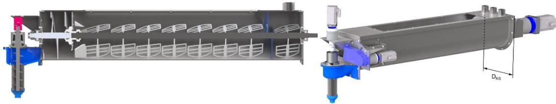
**Bild 5:** Links: Querschnitt des Mischsystems ohne Antriebselemente mit dem Zulaufbereich rechter Rand, Nassmisch- und Förderbereich mitte und Kompressionsbereich links vertikal angeordnet;
