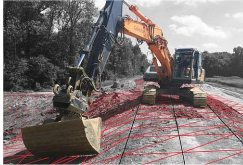
**Bild 1:** Geländenetz beim 3D Geländeabbagern. [1]
