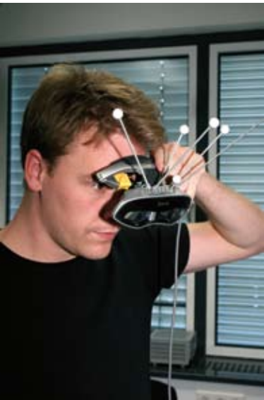
Erweiterte Realität: zusätzlich zur realen Umgebung werden über die Datenbrille weitere Informationen eingeblendet
