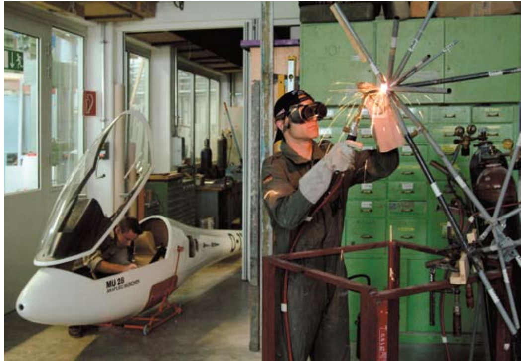
Arbeiten der Akaflieg München an einem Segelflugzeug in Verbundbauweise
