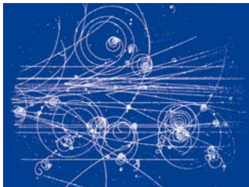
links: Von hochenergetischen Partikeln hinterlassene Spuren in einer Blasenkammer
