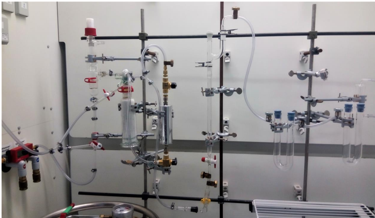
Abb. 3.28: Fotografie der finalen Oligomerisierungsapparatur.
