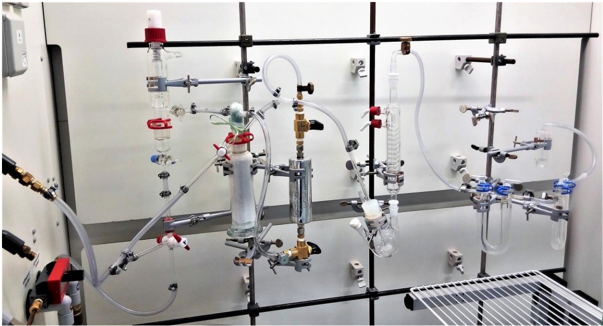
Abb. 3.29: Fotografie der Oligomerisierungsapparatur mit einem Dreihalskolben als Reaktionsgefäß.
