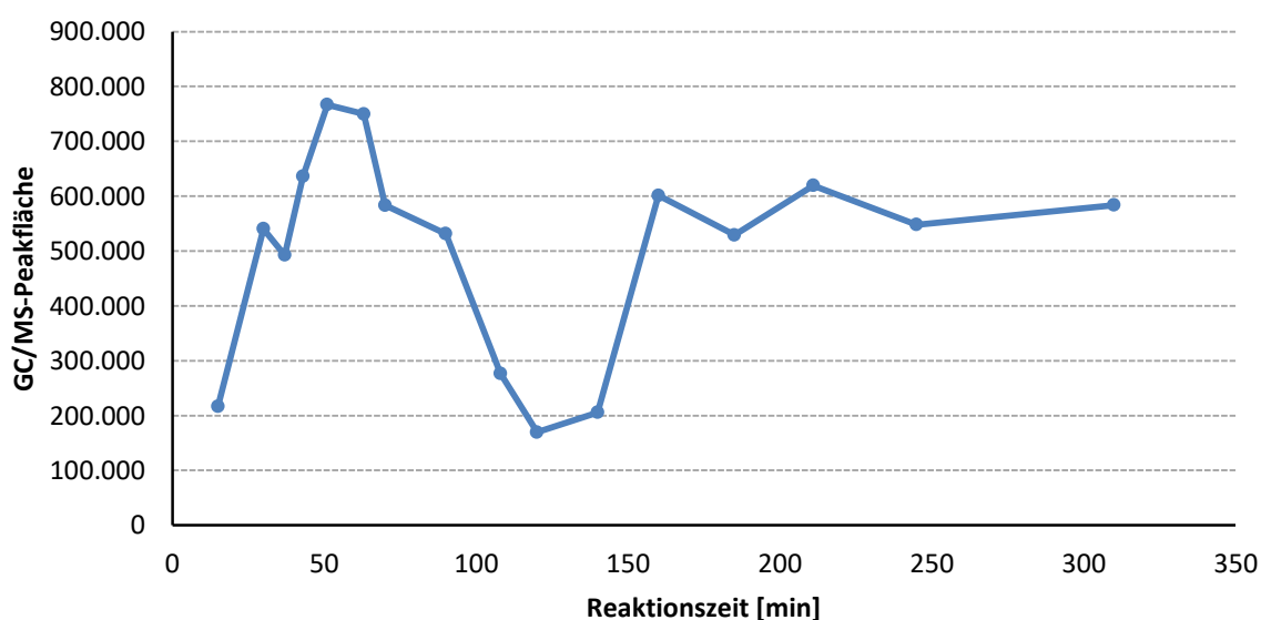
Abb. 3.38: Entwicklung der GC/MS-Peackflächen der C_4 -Fraktion im Reaktionsverlauf der Oligomerisierung von Ethen mit K6 und AlEt_2Cl .
