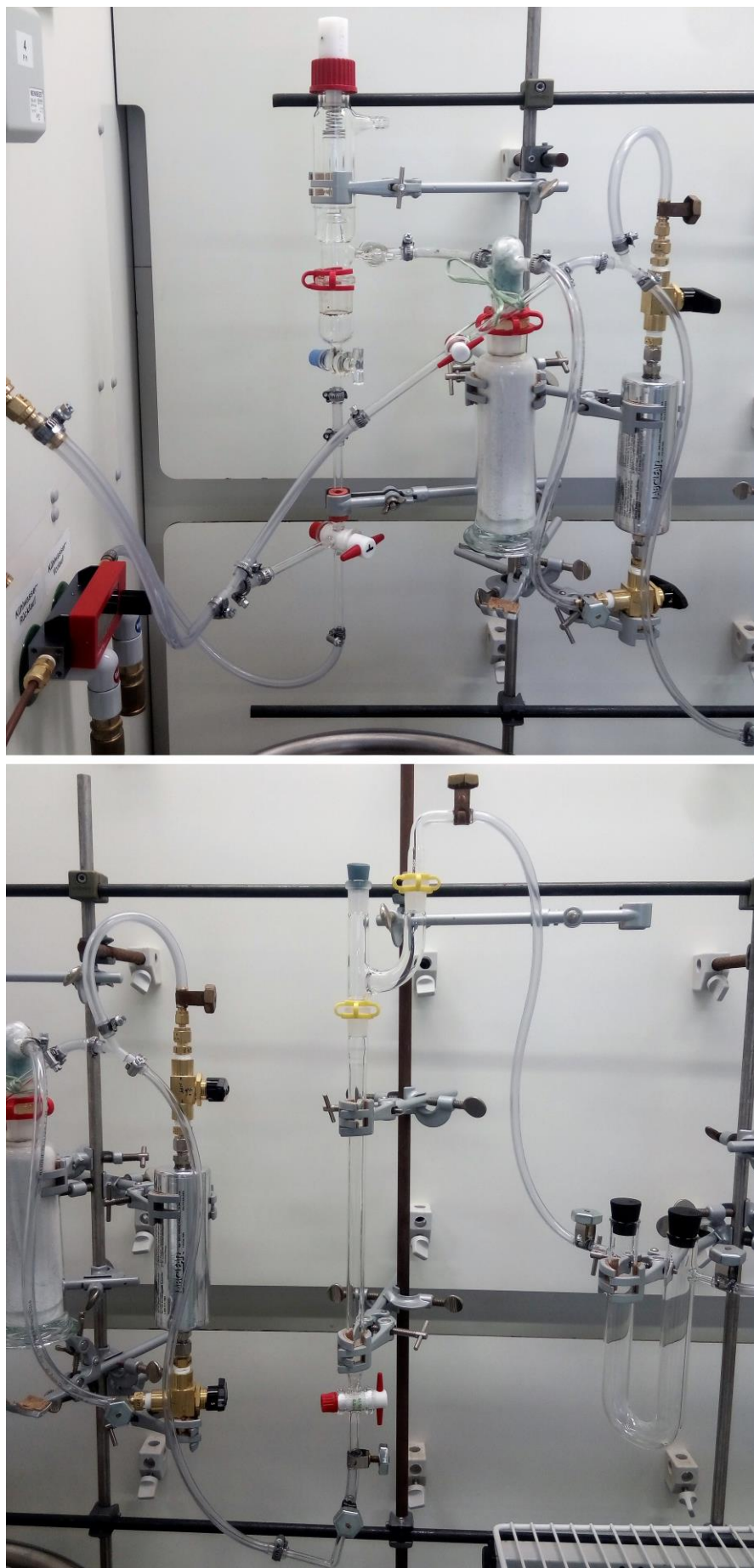
Abb. 3.30: Nahaufnahmen der Gasreinigung und der Reaktionssäule.
