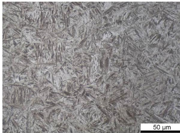
Detailaufnahme Kerngefüge – bainitisches Kerngefüge
