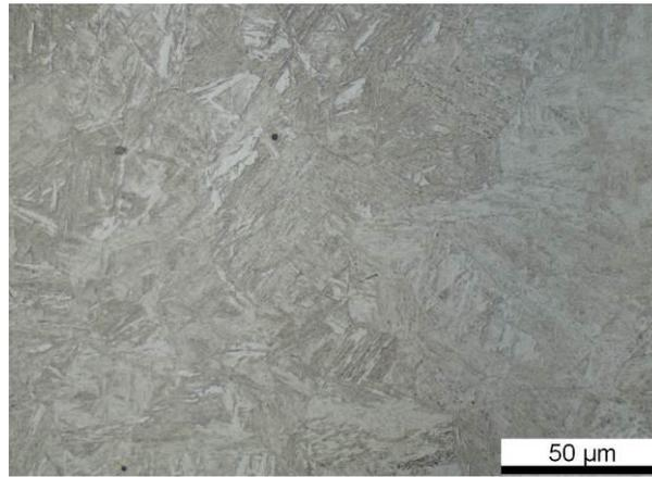
Detailaufnahme Kerngefüge – bainitisches Kerngefüge
