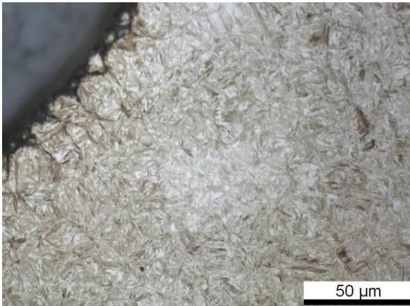
Detailaufnahme Randzonengefüge Zahnfuß (nital geätzt) – Martensit mit Restaustenit
