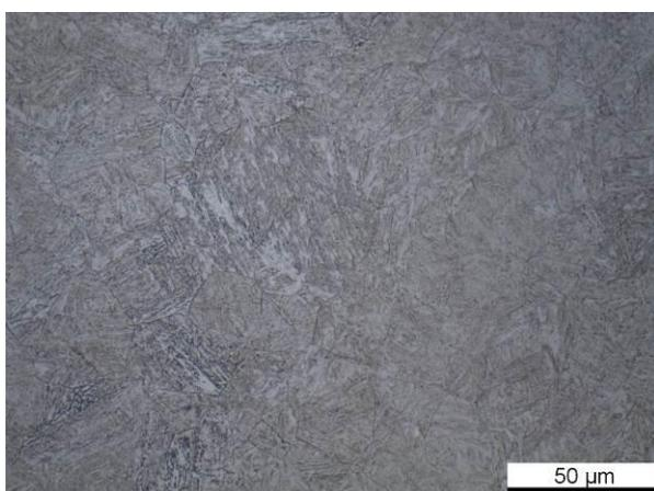
Detailaufnahme Kerngefüge – bainitisches Kerngefüge
