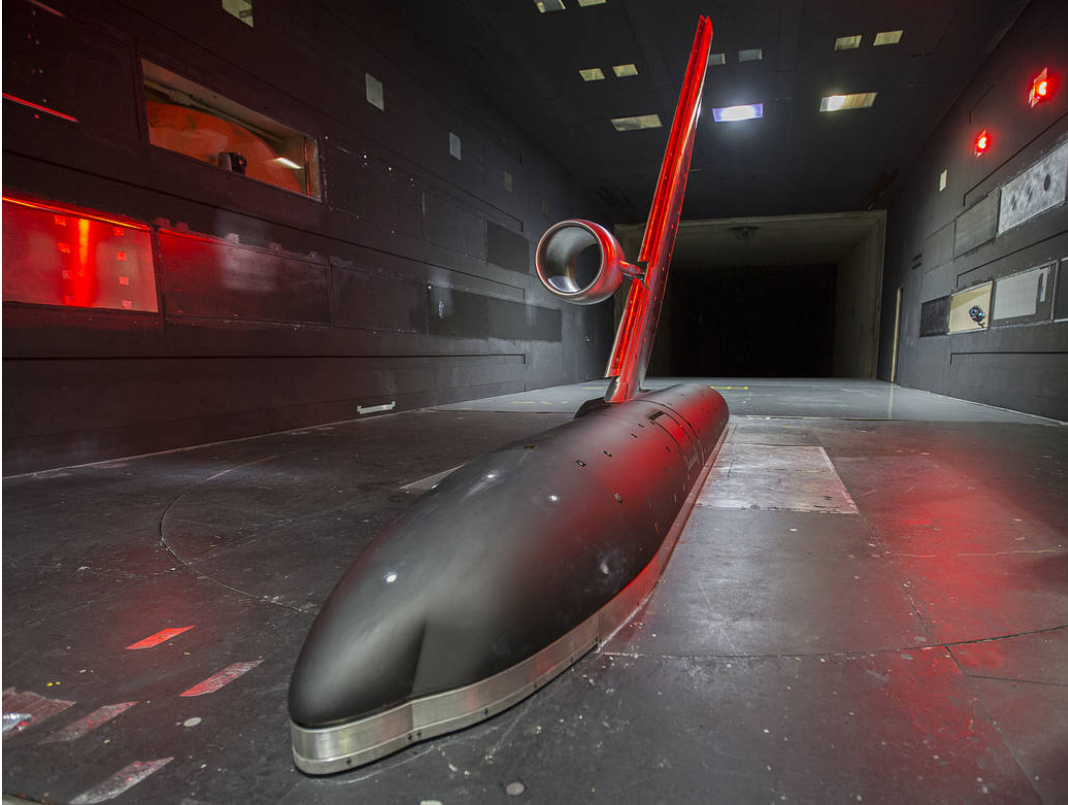
Abbildung 3.1: Halbmodell der Hochauftriebskonfiguration von „NASA Common Research Model“ (CRM-HL) im Langley-Unterschallwindkanal [11].
