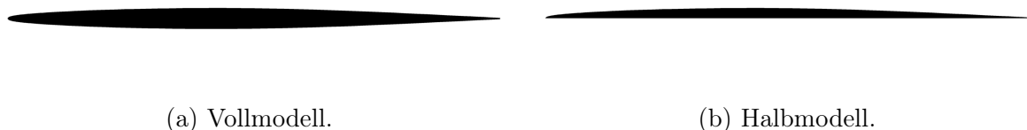
Abbildung 3.8: Querschnitt des AGARD 445.6-Flügels für den Voll- und Halbmodellfall.
