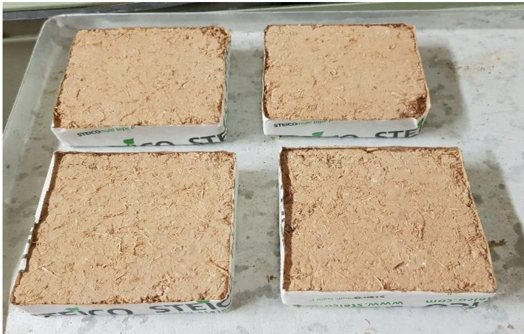
Abb. 61 - Seitliche Stabilisierung der Lehmbauplatte mit Klebeband
