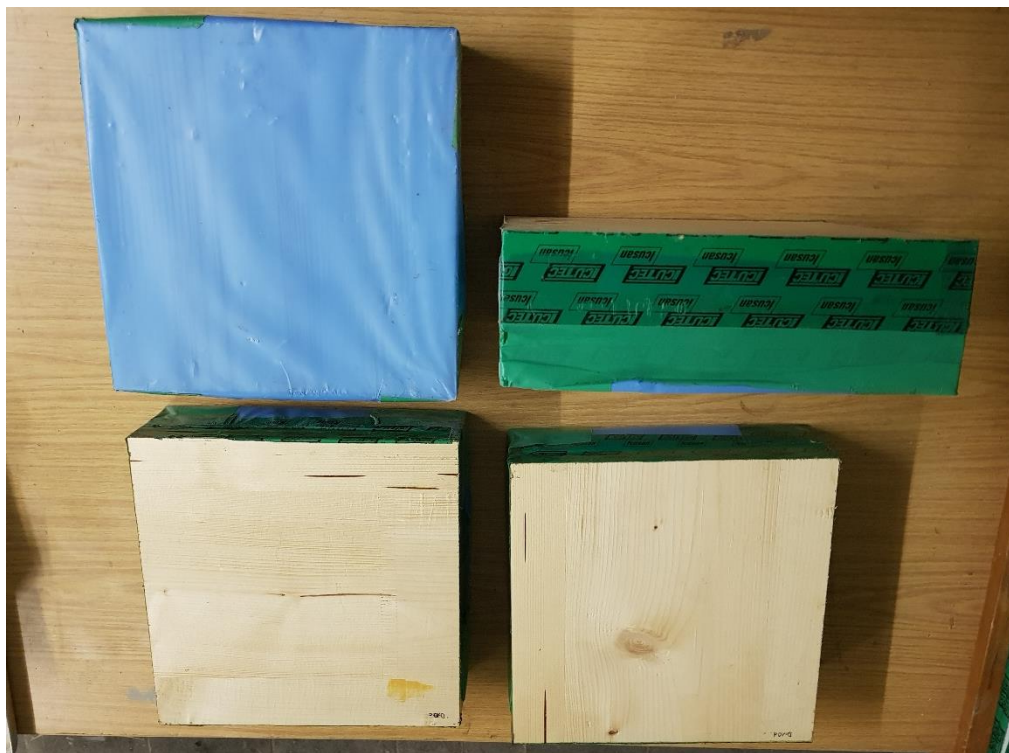
Abb. 33 - Versiegelte Brettsperrholzproben für die Messung der dynamischen Sorptionsfähigkeit
