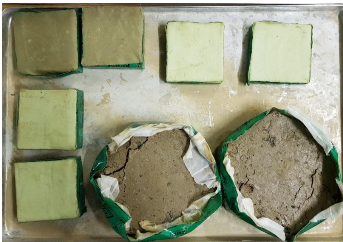
Abb. 73 - Formverlust bei vollständig durchfeuchteten Lehmwerkstoffen
