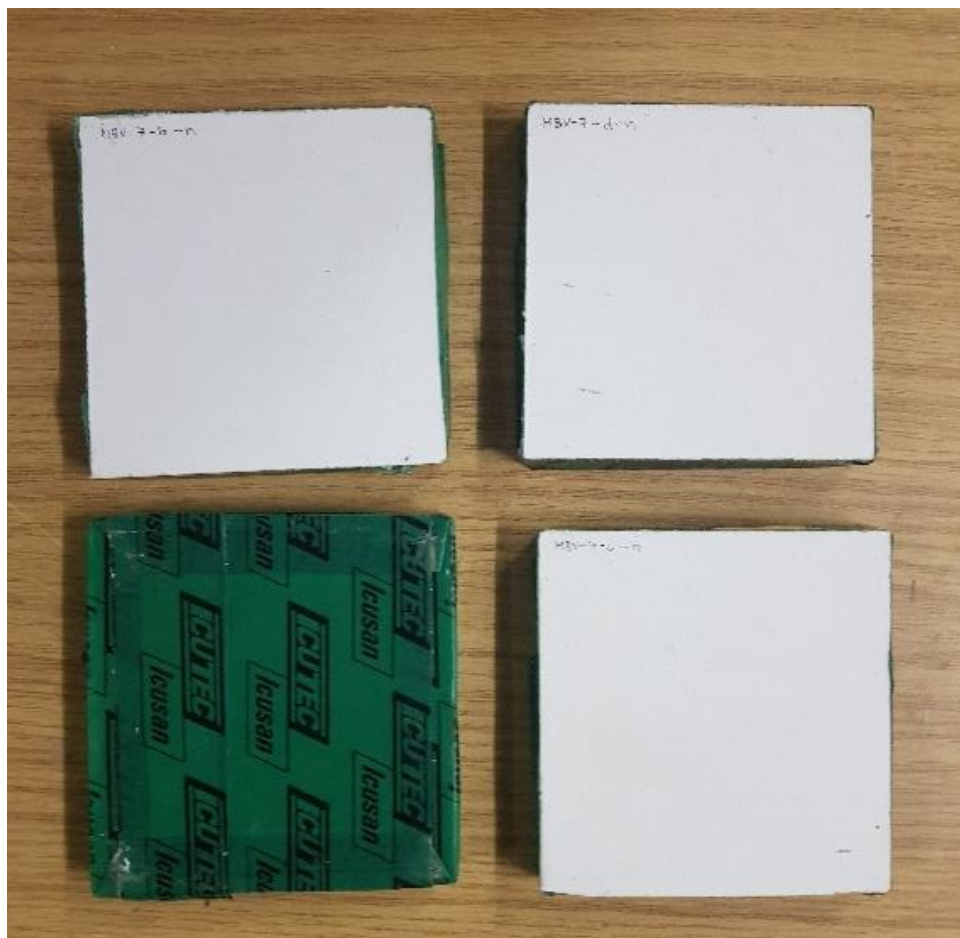
Abb. 34 - seitlich versiegelte Gipskartonprobe mit Kalkfarbe für Feuchtepuffermessung
