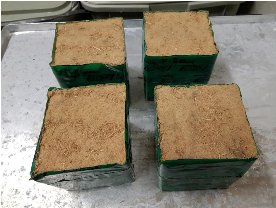
Abb. 31 - Holzfaserdämmung (weich) mit durch Klebeband versiegelten Seiten
