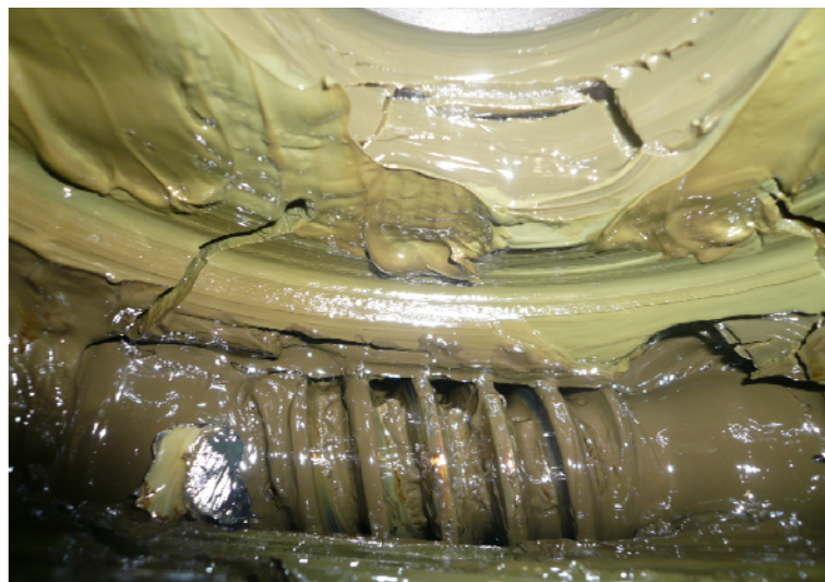
Bild 30: Nachschmierungsmechanismus: Fließfähiger Fettsumpf um die Schnecke in ansonsten konsistentem Fett
