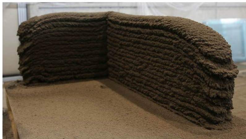
Abbildung 5.11: Shotcrete-Bauteil mit Fehlstellen an den Enden und der Ecke.
