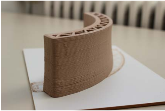
Abbildung 6.4: Erfolgreicher Druckversuch in voller Modellgröße.
