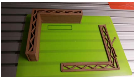
Abbildung 6.2: Kalibrierung des Druckvorgangs durch die Extrusionsrate.
