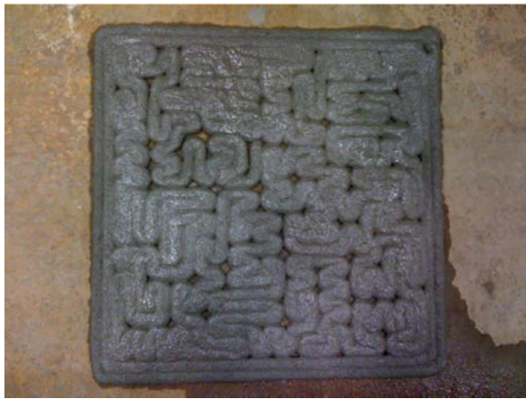
Abbildung 5.9: Druckkörper mit mehreren Richtungswechseln und daraus entstehenden Fehlstellen. (BUSWELL et al., 2018)
