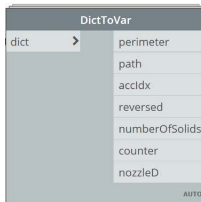
Abbildung 5.17: Übergabeparameter der Pfadgenerierungsmodul.
