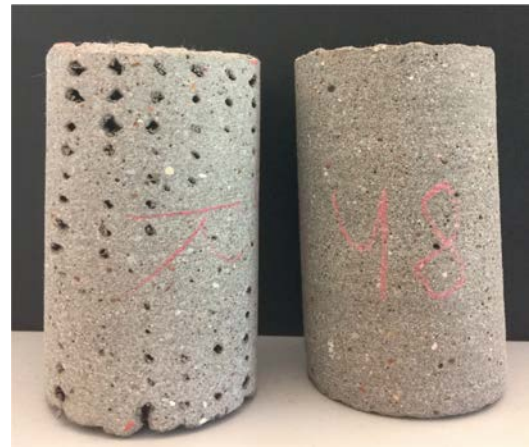
Abbildung 5.10: Beispiel-Druckkörper in guter (rechts) und schlechter (links) Qualität. (BUSWELL et al., 2018)
