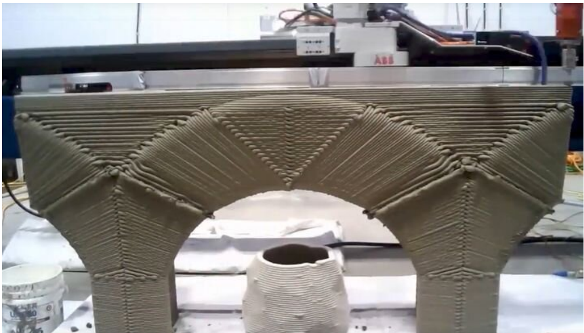
(c) 3D gedruckter Überhang. (STEVENSÓN, 2020)
