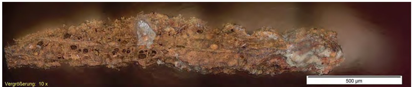
Abb. 132.:ID 15752, Befund 5, Unterseite, Holzprobe, Querschnitt, zerstreuporige Anordnung der Gefäße und zwei- bis dreireihige Markstrahlen
