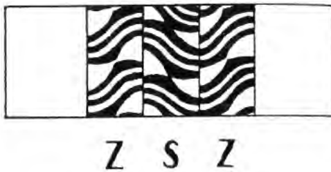
Abb. 6.:Schematische Darstellung der Torsionsrichtungen an der Torsionsstäben
