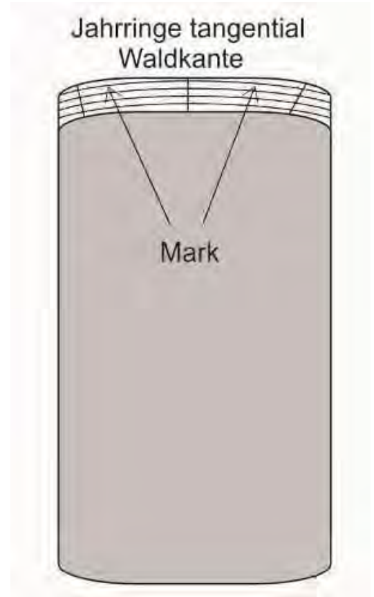
Abb. 181.: Zuschnitt der Scheidenhälfte in tangentialer Richtung
