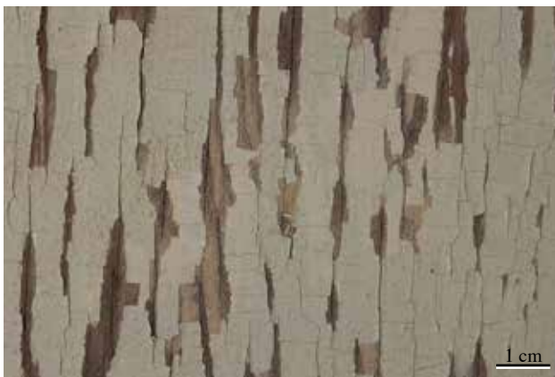
Abb. 93 Außenseite, Ablättern der Farbschicht
