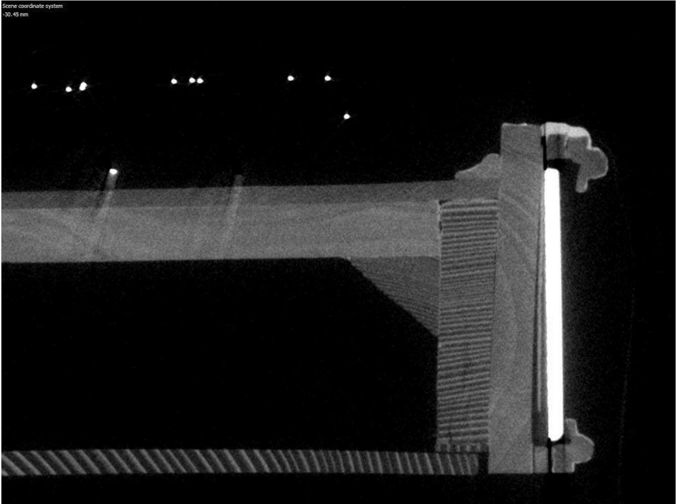
Abb. 41: CT-Schnittbild, senkrecht zur Vorderwand; Aufbau der Zarge
