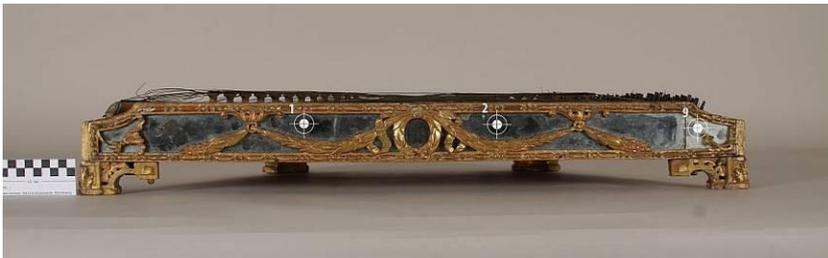
Abb. 74: Messpunkte für RFA auf der Vorderwand
