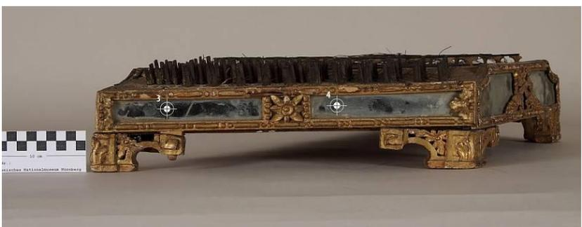
Abb. 77: Messpunkte für RFA auf der rechten Seitenwand
