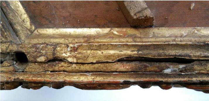
Abb. 111: Reinigungsprobe mit Ethanol-Wasser-Gemisch im Verhältnis 70 : 30
