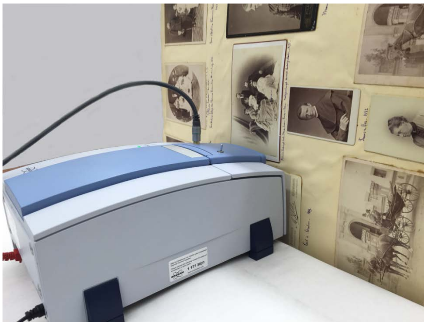
Abb. 87 FRONT-REFL-Einheit an Bruker Alpha FT-IR-Spektroskop vor Portr.T.1038 Quelle: Nadine Bretz / IBR
