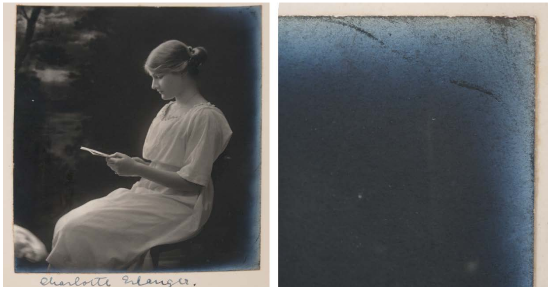
Abb. 19 + 20 Silberspiegel auf matter Gelatine Aufnahme 77/8 Quelle: Nadine Bretz / IBR
