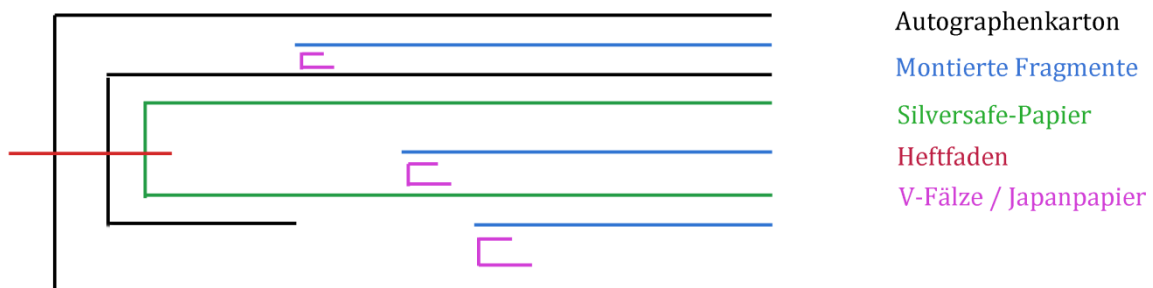
Abb. 81 Konstruktionszeichnung der Fragmentmappe Quelle: Nadine Bretz / IBR
