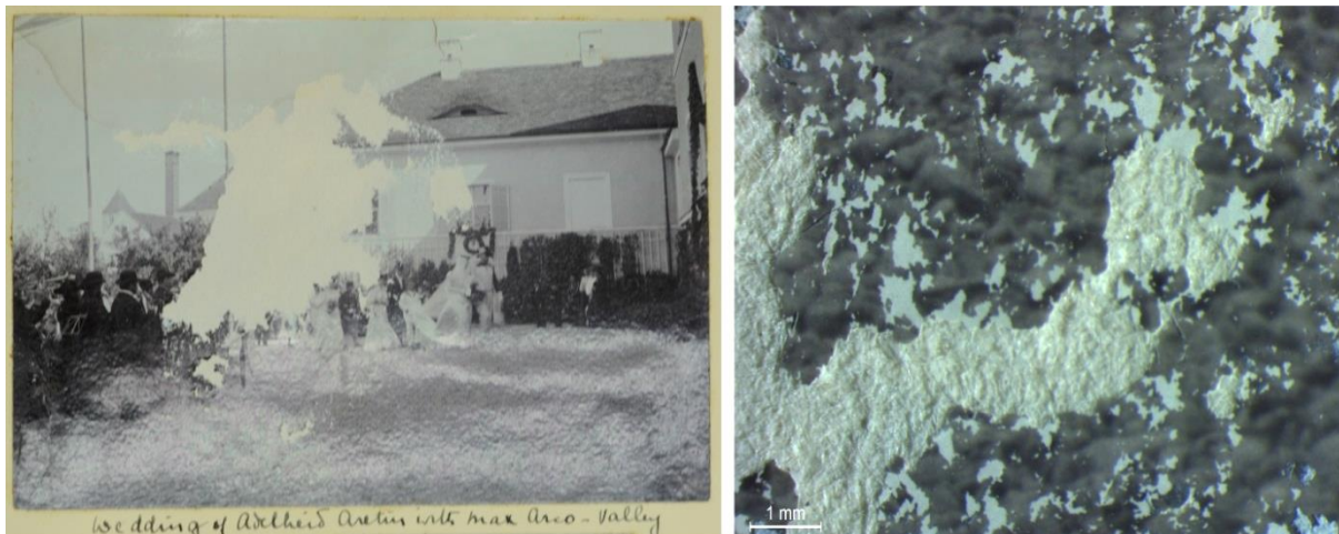
Abb. 66 + 67: Fotografie 57/2 : Gesamtaufnahme links, Mikroskopaufnahme (rechts): Ausgerissene Bildschicht der Fotografie 56/2 + Fehlstellen in der Bildschicht Quelle: Nadine Bretz / IBR
