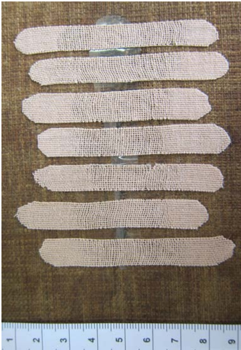
Abbildung A-5: GG 7120, Linearer Riss während der Risszusammenführung. Spannungsdifferenzen innerhalb des Tapes sind an den unregelmäßig ausgebildeten Hohlräumen erkennbar.
