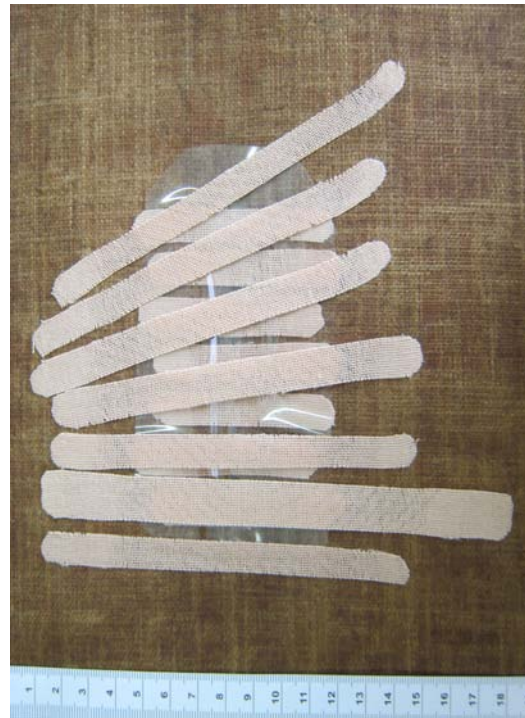
Abbildung A-6: GG 7120, Linearer Riss während der Risszusammenführung. KT-Streifen wurden aufgrund eines diagonalen Verzugs schräg auf dem Bildträger appliziert.
