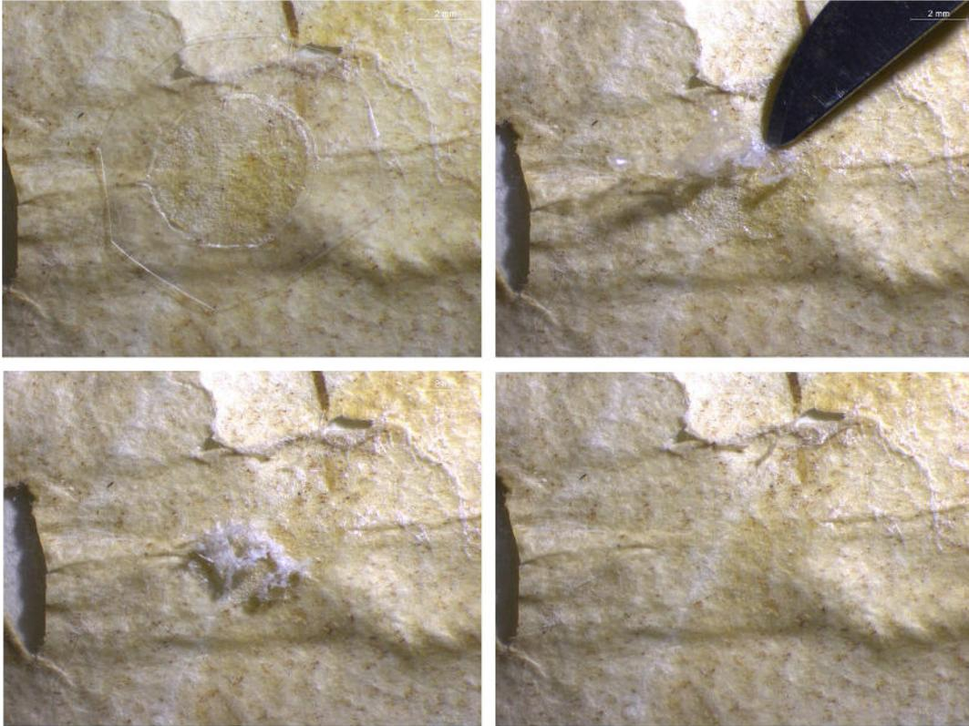
Abb. 25: Entfernung eines Laminierungspunktes in mehreren Schritten
