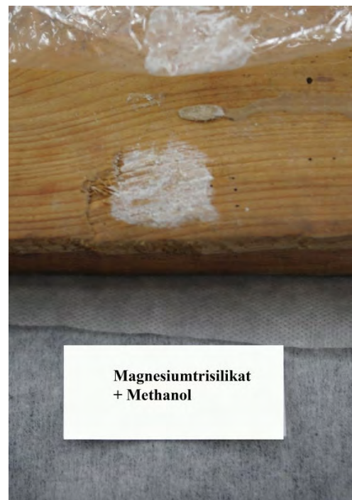
Abb. 45: Das Magnesiumtrisilikat migrierte durch das Japanpapier und schlug sich auf dem Holz nieder.
