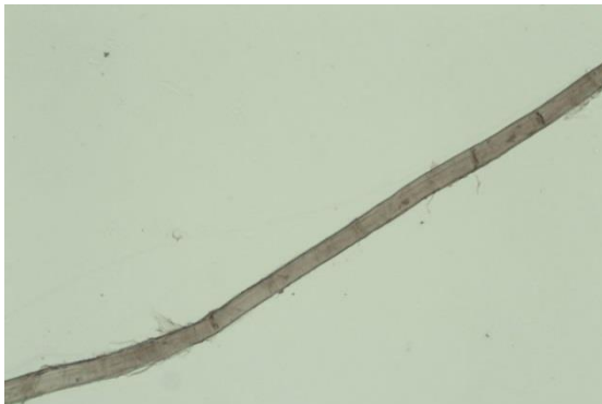
Abb. 16 Intakter Faserbereich mit durchsichtiger Hülle.
