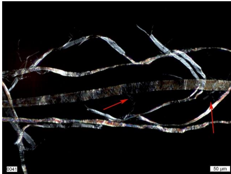
Abb. 23 Faser aus Abb. 25 in Dunkelstellung zwischen gekreuzten Polarisatoren.
