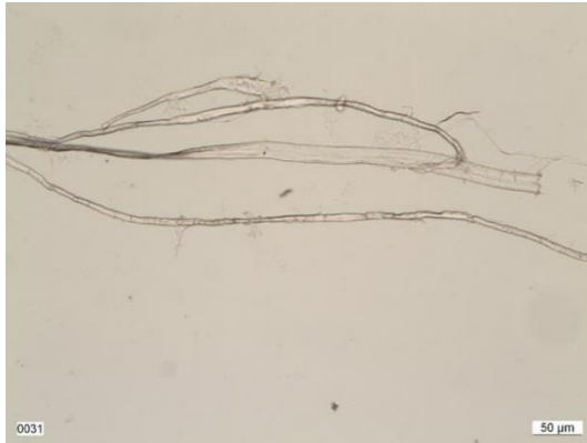
Abb. 30 Beschädigtes und aufgespaltenes Faserende.
