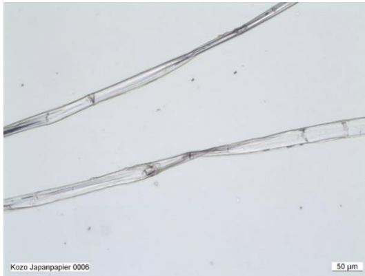
Abb. 34 Flache, in sich gedrehte Kozo-Faser aus einem Japanpapier.
