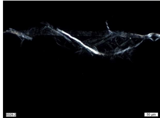
Abb. 31 Faserreste aus Abb. 30, 31 unter gekreuzten Polarisatoren in Dunkelstellung.
