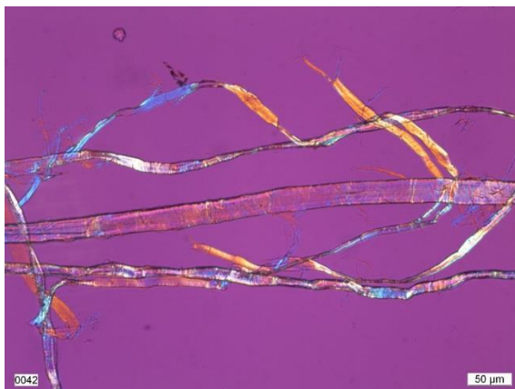
Abb. 24 Gekreuzte Polarisatoren mit Lambda-Platte. O-W-Richtung → Orange I.
