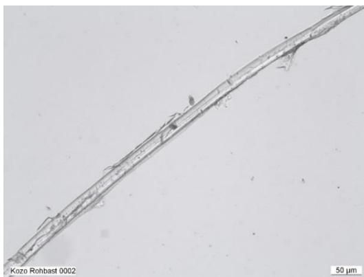
Abb. 32 Kozo-Faser aus Rohbast mit umgebender transparenter Membrane.
