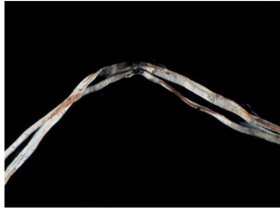
Abb. 21 Flache, in sich gedrehte Faser unter gekreuzten Polarisatoren.
