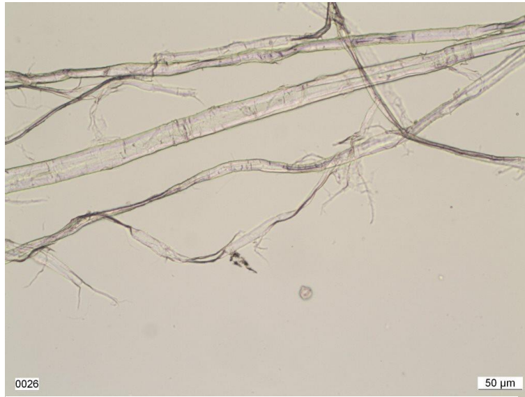
Abb. 22 Dauerpräparat 2 – intakte Fasern.
