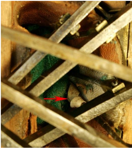
Abb. 50: Pedalstange, mit Stoffstreifen umwickelt
