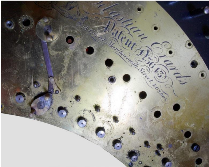
Abb. 53: Achsen der unteren Gabelscheiben
