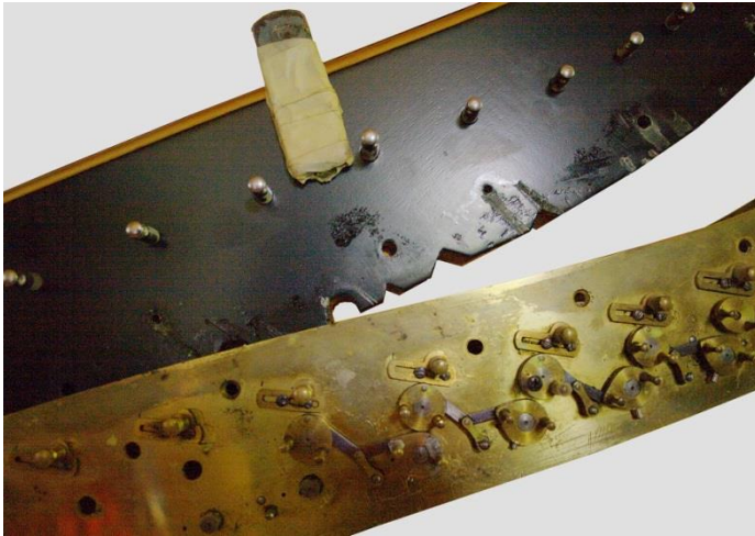
Abb. 55: Aussparungen in der Halsunterseite
