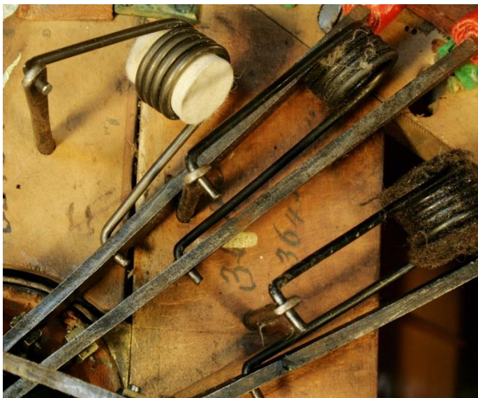
Abb. 49: Fixierung der Rückstellfedern
