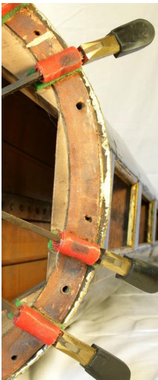
Abb. 41: Befestigungslöcher des Pedalkastens im Bodenbrett
