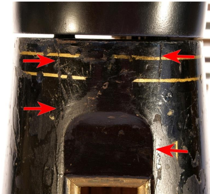
Abb. 24: Steg zur Begrenzung der Schallöffnungen An Ober- und Unterklotz wurden profilierte Stege geleimt, die die Schallöffnungen begrenzen sollten. Im Spalt zwischen Schulter und Korpus ist ein Dübel zu erkennen, mit dem die beiden Teile verbunden sind.
