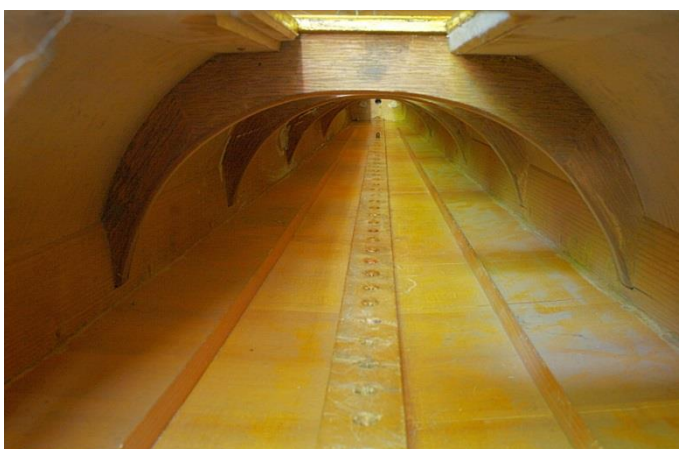
Abb. 25: Korpus, innen Die Resonanzdecke zeigt auf der Aufnahme nach unten. In der Mitte der Decke verläuft der innere Saitensteg, daneben die Bassbalken. Am Übergang von Decke zu Korpuschale befinden sich die seitlichen Korpusleisten. Die Rippen schmiegen sich an die Korpuschale an und stabilisieren diese.
