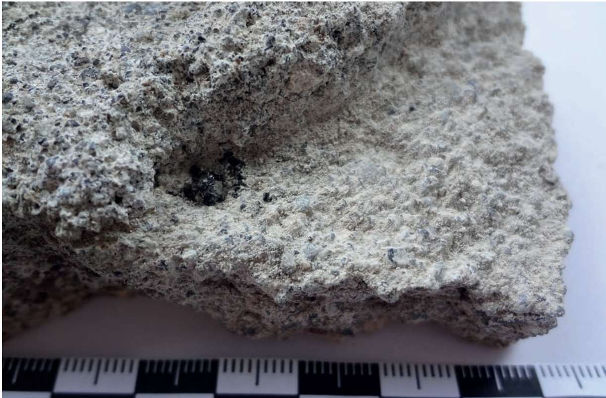
Abb. 110: Fragment 8_4 während der Schichtentrennung: bei dem braunen Partikel in der zweiten Unterputzschicht handelt es sich vermutlich um Holzkohle.
