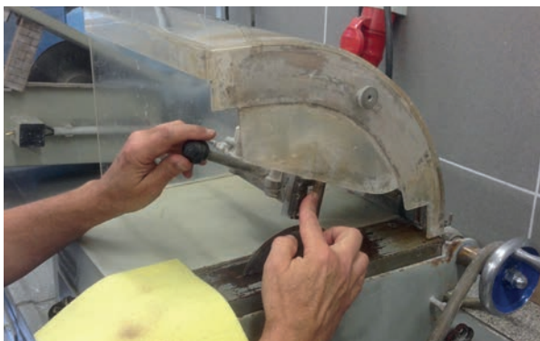
Abb. 41: Abtrennen des Dünnschliffes vom Anschliff.
