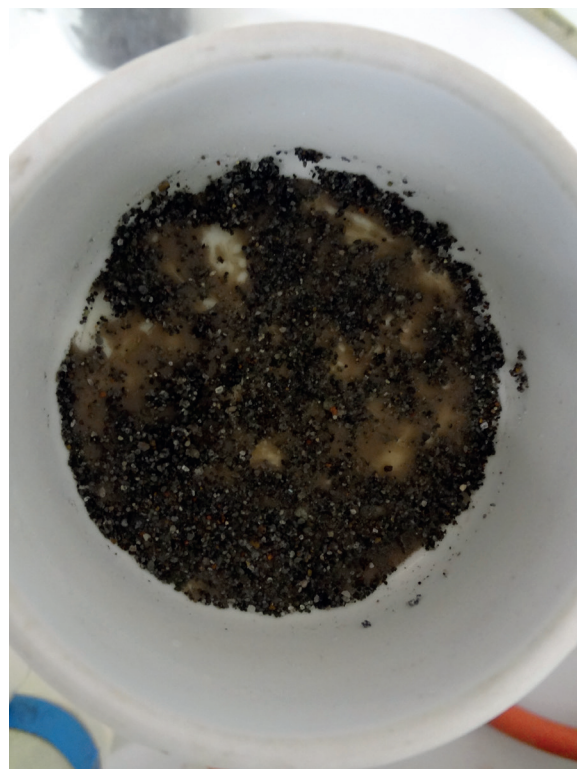
Abb. 88: Rückstand in der Filternutsche. Deutlich zu sehen ist der schlammige Feinanteil (hier Probe 9_5_6_1).
