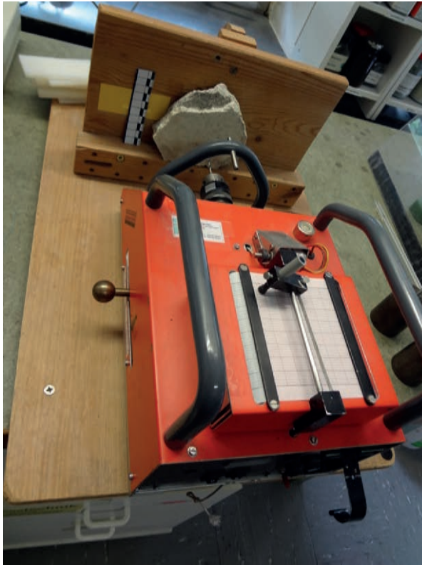
Abb. 50: Bohrwiderstandsprüfgerät DURABO des Fachlabors – Dr. Wendler – für Konservierungsfragen in der Denkmalpflege
