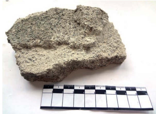
Abb. 84: Fragment 8_4 (EN 4), Schichtentrennung für Säureaufschluss, Freilegung von Schicht 2.
