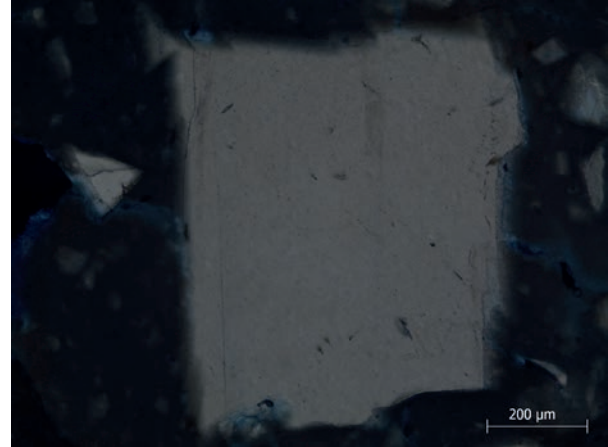
Abb. 156: Calcit mit charakteristischer Interferenzfarbe von Grau-hoher-Ordnung (Durchlicht xPol).
