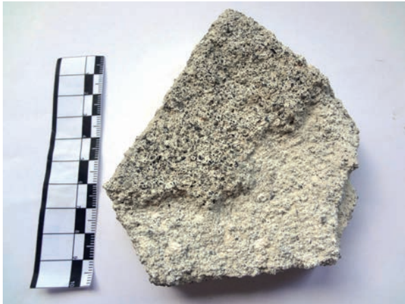
Abb. 83: Fragment 9_5 (EN 6), Schichtentrennung für Säureaufschluss, Freilegung von Schicht 2.
