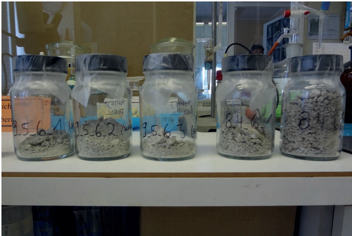
Abb. 86: Für den Säureaufschluss getrennte Schichten des Fragments 9_5 (EN 6) und 8_4 (EN 4).
