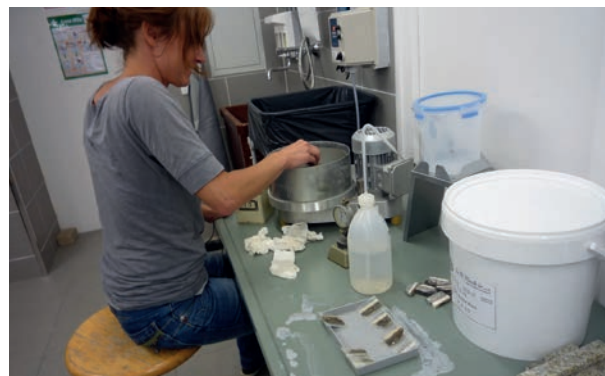
Abb. 42: Reduktion der Dünnschliffdicke auf etwa 100 µm per Handschliff auf einer rotierenden Schleifscheibe.
