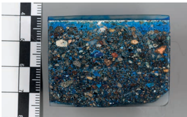
Abb. 47: Anschliff 8_4_2 des Grabbaus EN 4: Der obere halbe Millimeter des Oberputzes zeigt keine Blaufärbung.
