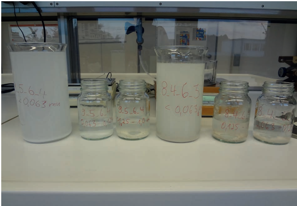
Abb. 94: Proben 9_5_6_4 (links) und 8_4_6_3 (rechts) nach der Siebung (hier: Korngrößen unter 1,0 mm). Anhand der Suspensionen der Fraktion unter 0,063 mm sind Farbunterschiede zwischen den Proben erkennbar. Nach dem Absetzen der Partikel wurde das klare Wasser abgesaugt und die Rückstände getrocknet.
