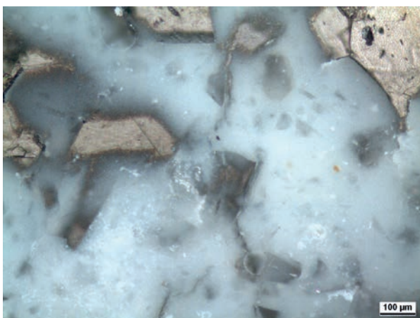
Abb. 126: Grabbau EN 6: Weiß-beige Farbigkeit und homogene Struktur des Bindemittels des Oberputzes (Auflicht Dunkelfeld, Dünnschliff 7_3_1).
