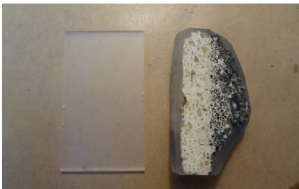
Abb. 39: Einseitig angeschliffener Objektträger und imprägnierte, geschliffene Probe.
