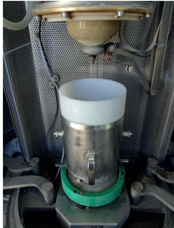
Abb. 91: Elektrodynamischen Fragmentierung: Stabelektrode und mit Wasser gefüllter Probenbehälter.
