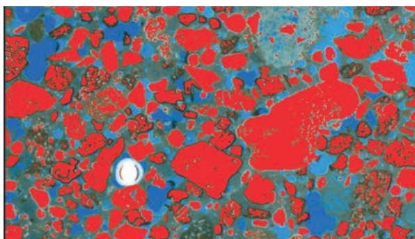
Abb. 62: Mit Rot gefüllte Auswahl des Zuschlages über die Durchlichtaufnahme.
