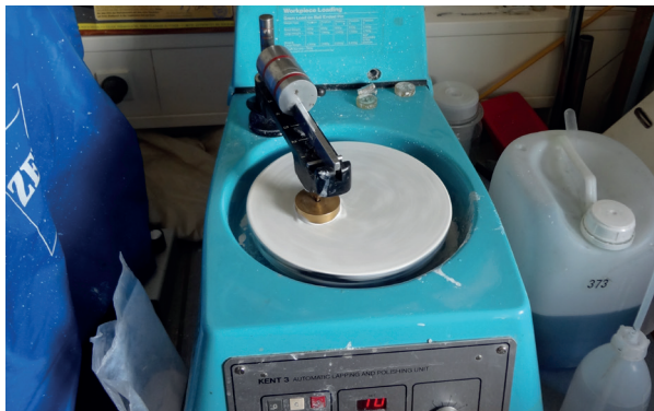
Abb. 43: Endpolitur der Dünnschliffe mit Ceroxid-alpha weiß.
