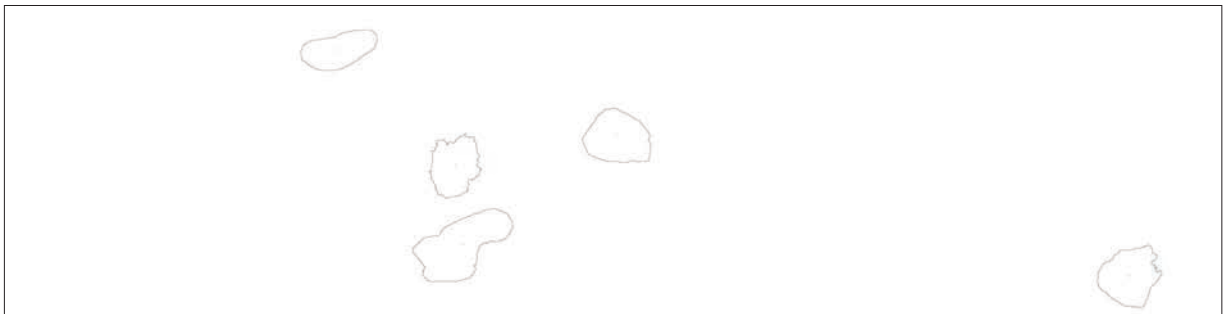
Abb. 77: Darstellung der Erfassten Zuschlagskörner der Klasse über 2 mm. Der prozentuale Anteil der detektierten Körner dieser Klasse hat sich durch die manuelle Nachbearbeitung deutlich reduziert. Es sind keine verwachsenen Agglomerate mehr zu erkennen.
