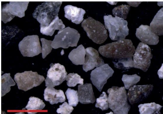
Abb. 106: elektrodynamisch fragmentierter, nachgestellter Unterputz 250 – 500 µm (roter Balken: 1,0 mm)
