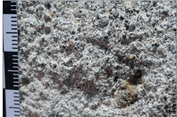
Abb. 14: Grabbau EN 6: Unterputz mit auffällig hohem Anteil an Kornklassen von 0,5 bis 1 mit vereinzelt Größtkorn über 2 mm. Das Bindemittel zeigt eine weißlich-beige Farbigkeit.
