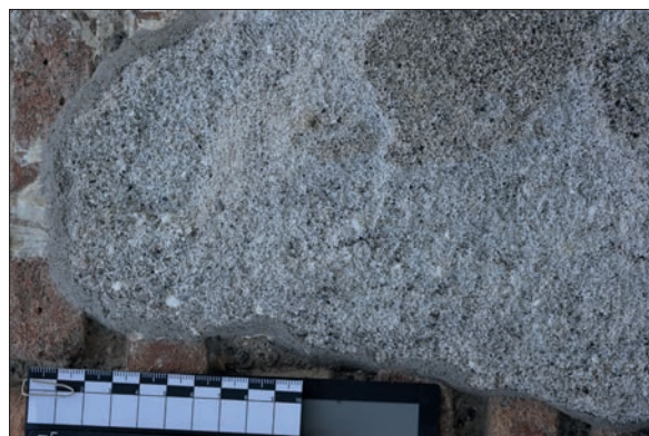
Abb. 12: Grabbau EN 6: Unterputz mit Kalkgallen und einem geringeren Anteil an Grobkorn als EN 4.
