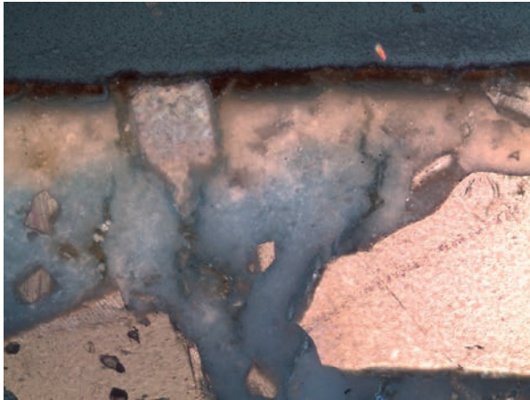
Abb. 133: Grabbau EN 4: In den oberen 0,2 mm des Oberputzes hatte das Präparat keine Blaufärbung angenommen. Zudem ist im Oberflächenbereich eine braune Verfärbung zu erkennen (Auflicht Dunkelfeld, blaugefärbter Dünnschliff 8_4_2).
