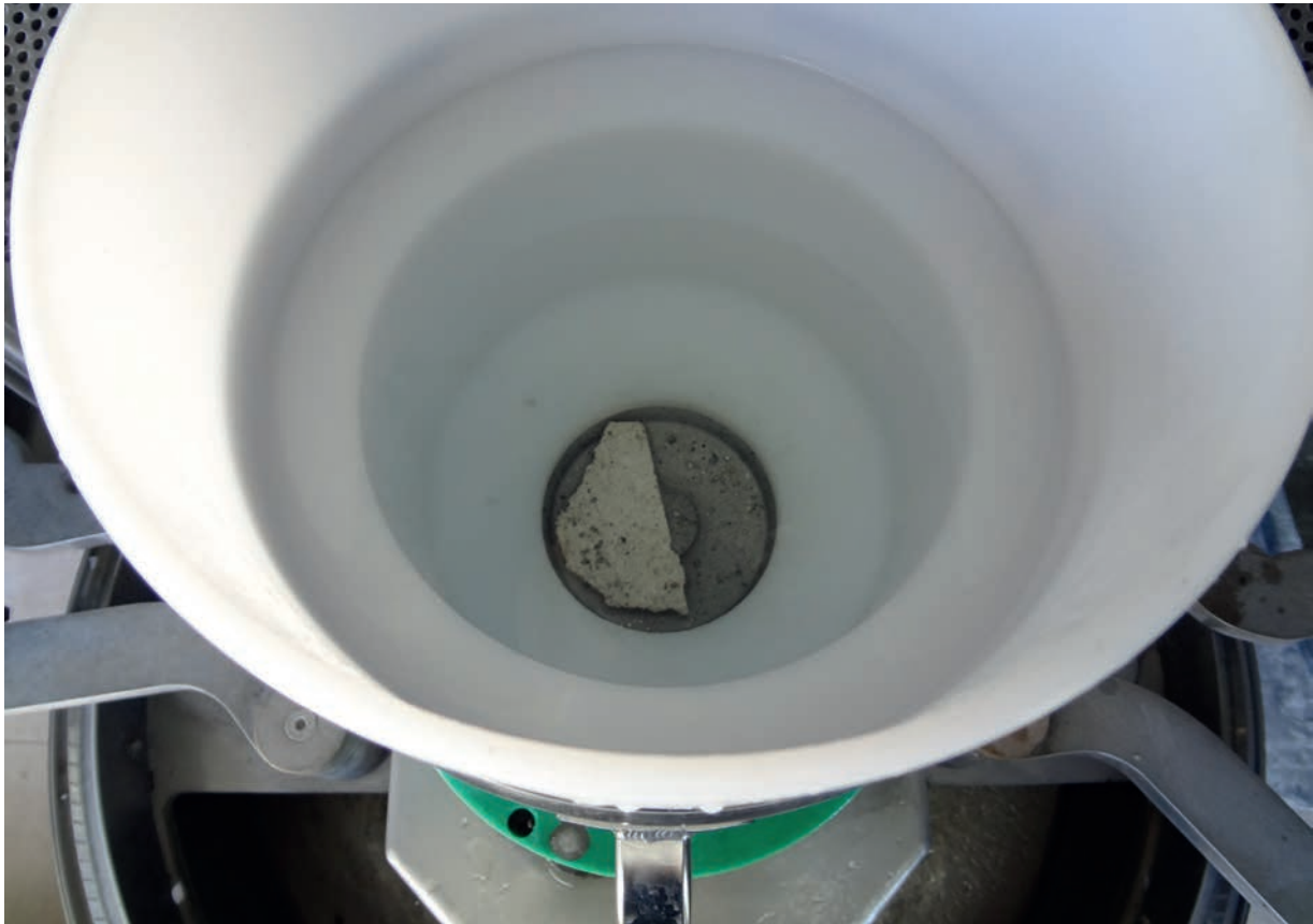
Abb. 92: Probe 8_4_6_3 vor der elektrodynamischen Fragmentierung. Die Probe befindet sich im Probenbehälter unter Wasser auf der Plattenelektrode.
