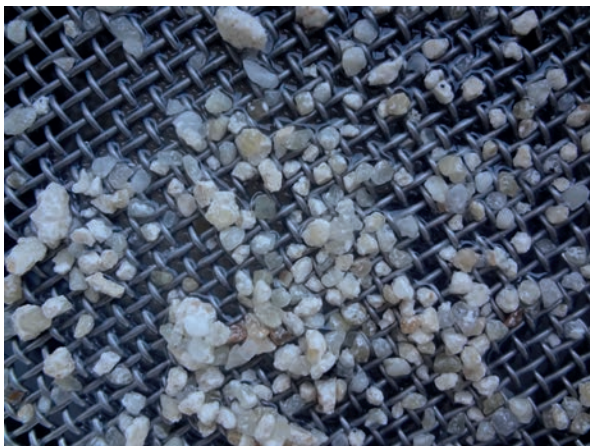
Abb. 93: Proben 9_5_6_4 (links) und 8_4_6_3 (rechts) unmittelbar nach der elektrodynamischen Fragmentierung: Aussiebung der Fraktion über 2 mm. Bei Probe 8_4_6_3 sind vermehrt Bindemittel-Zuschlag-Agglomerate vorhanden.
