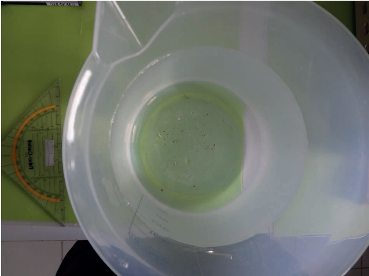
Abb. 52: Partikelrückstand im Messbecher nach der Wägung von acht Proben.
