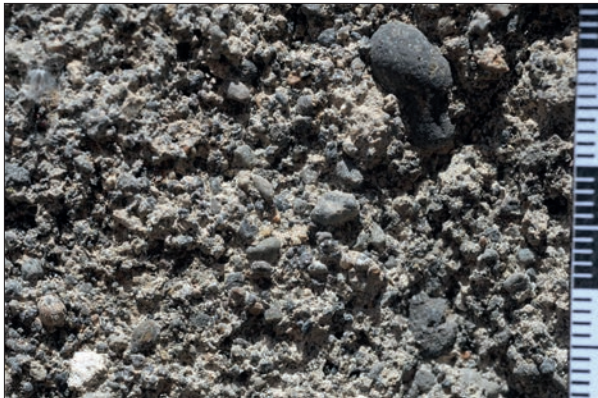
Abb. 15: Grabbau EN 4: Zweite Unterputzschicht mit deutlich größeren Zuschlägen im Bereich von 1 bis 2 mm, mit vermehrt Größtkorn über 2 mm und bräunlicher Matrixfarbigkeit.
