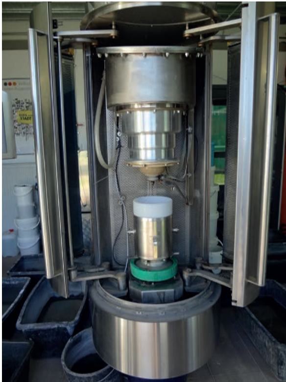
Abb. 90: Elektrodynamischen Fragmentierung: Gesamtansicht des Geräts im Fraunhofer Institut für Bauphysik Holzkirchen.
