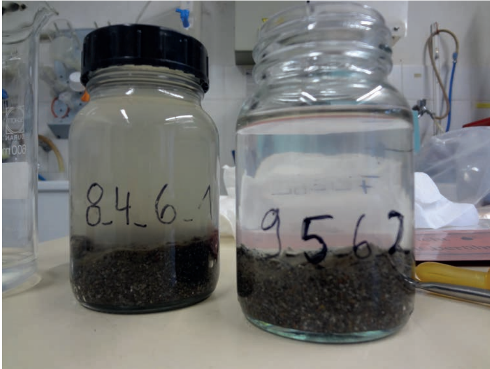
Abb. 89: Nach dem Absetzen des Feinanteils wurde das klare Wasser für die anschließende Trocknung des Rückstands abgesaugt.
