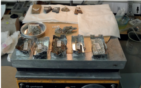
Abb. 35: Einbettung der Proben in Aluformen.
