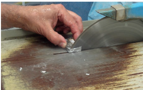
Abb. 37: Formatieren der eingebetteten Proben.
