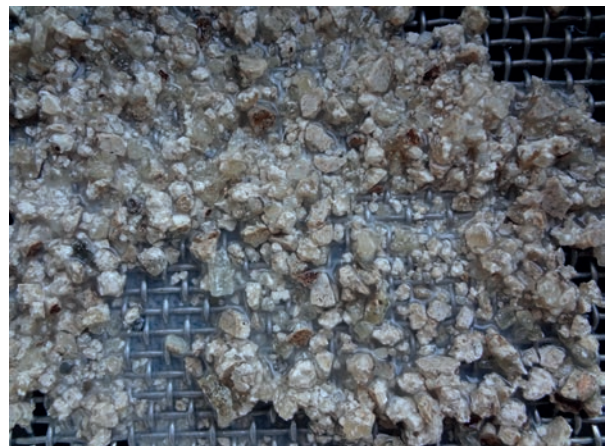
Abb. 93: Proben 9_5_6_4 (links) und 8_4_6_3 (rechts) unmittelbar nach der elektrodynamischen Fragmentierung: Aussiebung der Fraktion über 2 mm. Bei Probe 8_4_6_3 sind vermehrt Bindemittel-Zuschlag-Agglomerate vorhanden.
