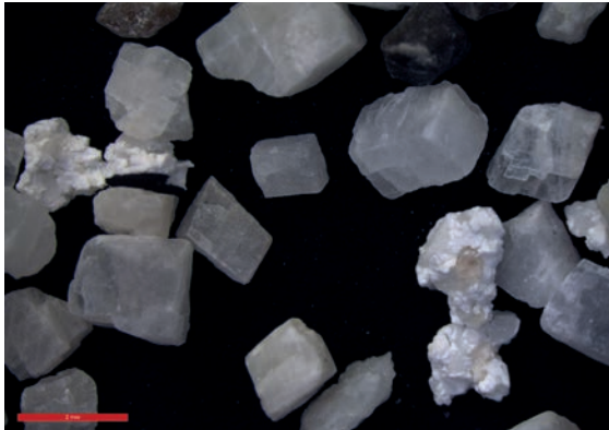
Abb. 102: elektrodynamisch fragmentierter, nachgestellter Oberputz > 1 mm (roter Balken: 2 mm)
