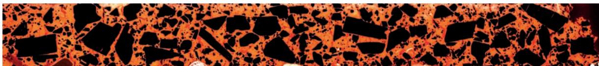
Abb. 59: Detail der Durchlichtaufnahme im Modus »negativ« des Dünnschliffes 8_4_2 (Oberputz)
