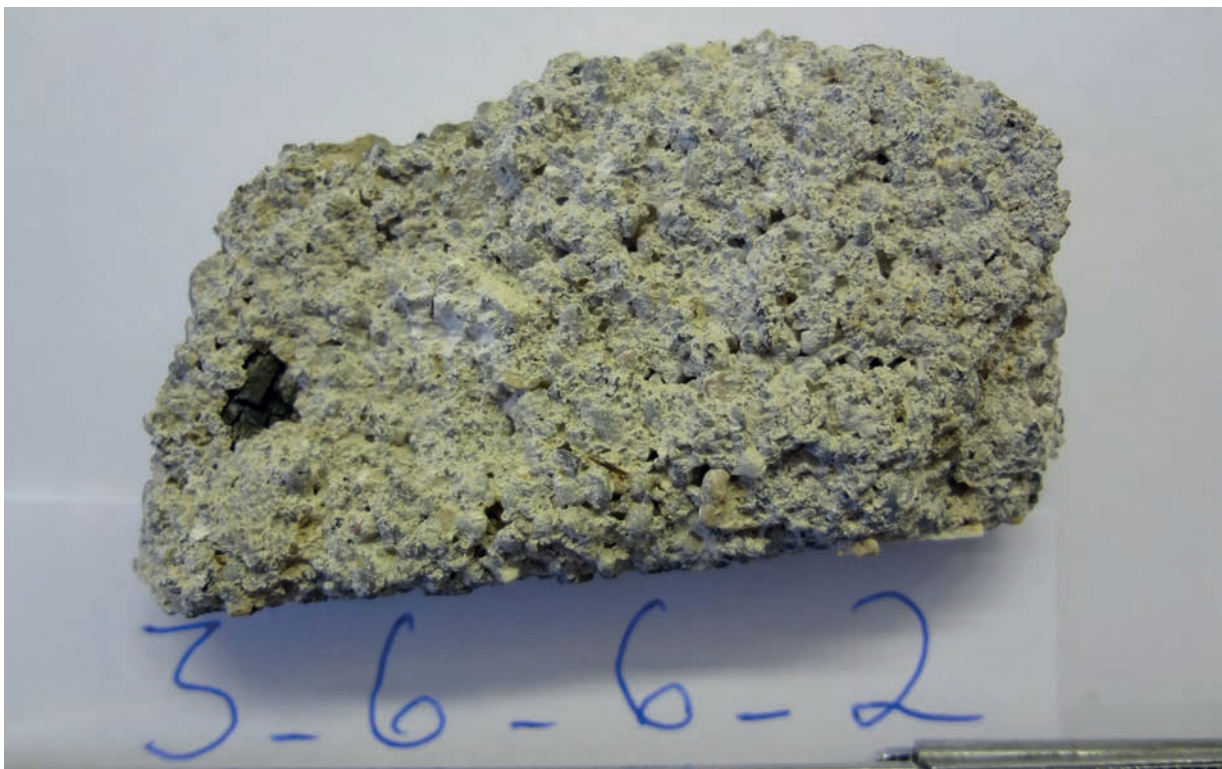
Abb. 111: Probe 3_6_6_2: bei dem braunen Partikel in der zweiten Unterputzschicht handelt es sich vermutlich um Holzkohle.
