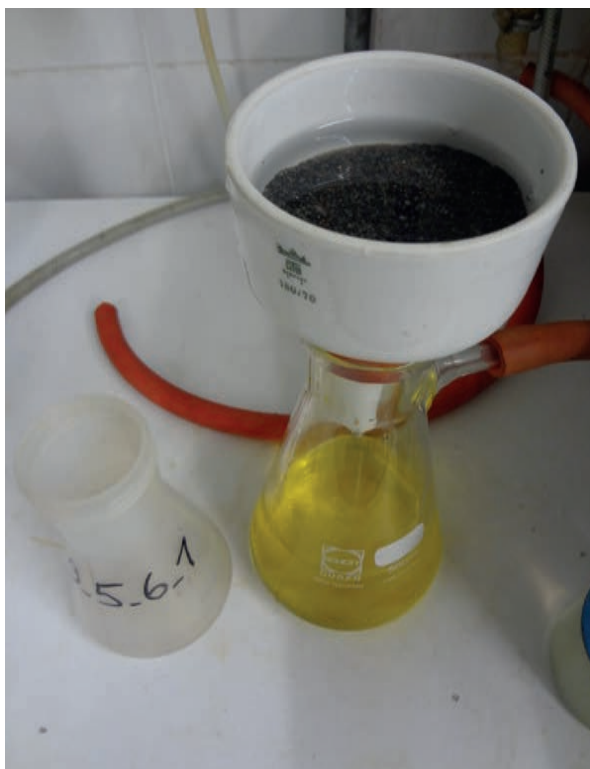
Abb. 87: Absaugung der Lösung nach dem Säureaufschluss mittels Wasserstrahlpumpe und Filternutsche (hier Probe 9_5_6_1).
