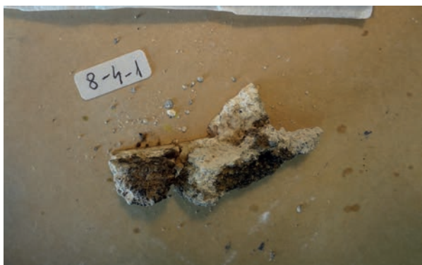
Abb. 45: Bei Schnitt zerbrochene Probe des Fragments 8_4.
