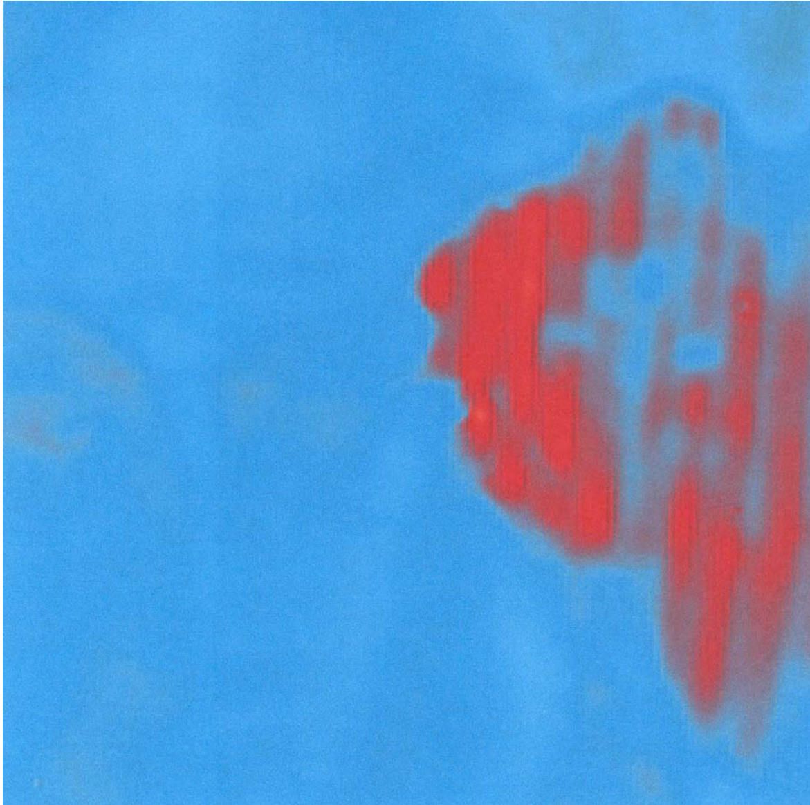
Abb. 52: Dieses Thermogramm wurde ca. 2,5 sec nach Blitzeinwirkung aufgenommen. Die Gesichtskonturen sind praktisch verschwunden, nur die zuvor erwärmten Stellen zeichnen sich weiterhin warm ab. Die Wärme ist inzwischen soweit eingedrungen, dass die senkrecht verlaufende Holzmaserung zu erkennen ist. Die Tatsache, dass sich diese beobachteten warmen Stellen sowohl im Bereich heller als auch dunkler Originalfarben befinden, lässt vermuten, dass es sich hier um Ablösungen der Farbe oder Kreidegrundes handelt.
