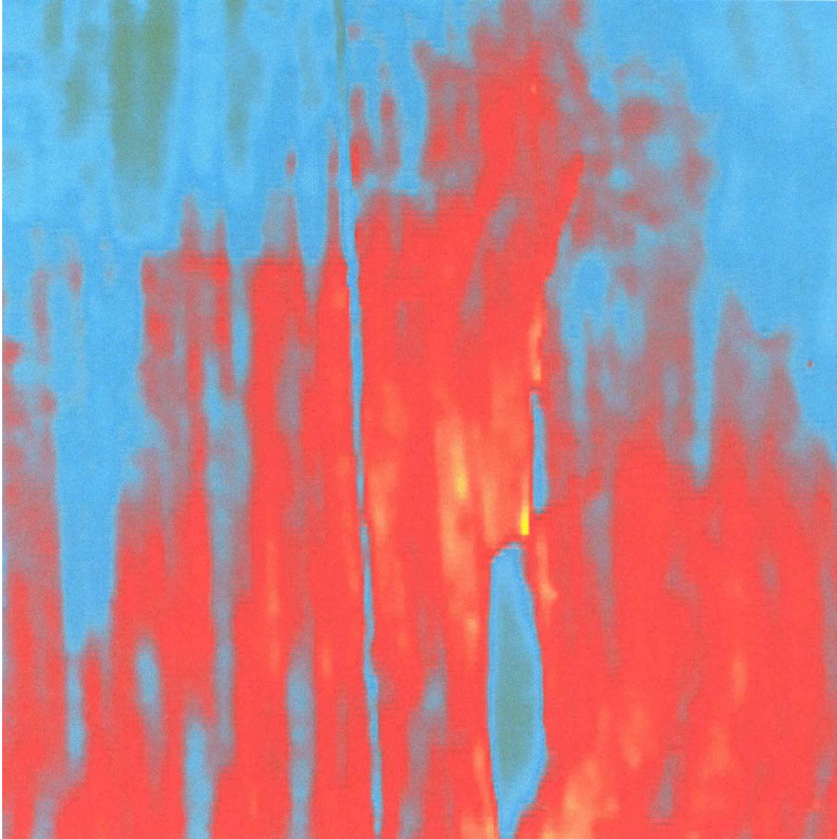
Abb. 37: Nach 4 sec ist der Wärmeimpuls tiefer eingedrungen, es zeichnen sich die Umrisse des Gewandausschnittes und des Brusttuches klarer ab. Die zuvor gelb erschienenen Fehlstellen sind nun rot. Die Kittstellen zeigen sich fast komplett im grünen Farbbereich. Die roten Farbbereiche, besonders oberhalb und seitlich der Kittstellen und am unteren rechten Bildrand, lassen sich als Haftungsdefizite interpretieren. Manche Ränder der Kittstellen weisen im Seitenlicht bei Überprüfung am Original leichte Schüsselbildungen auf, die sich im Temperaturprofil entlang der eingezeichneten Linie als stärker erwärmt erweisen.
