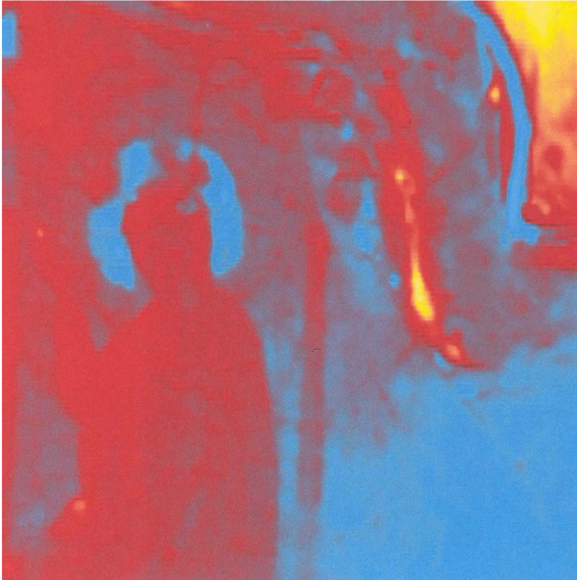
Abb. 44: Dieses Thermogramm wurde ca. 2,5 sec nach der Blitzeinwirkung aufgenommen. Die Konturen von helleren und dunkleren Originalfarben lassen sich auch nach weiterer Abkühlung noch erkennen. Der Bereich des Randes oben rechts erweist sich wahrscheinlich wegen einer Russablagerung, noch als erstaunlich warm gegenüber den anderen Bildbereichen. Die Hohlstelle an der Innenseite des Randwulstes ist weiterhin gut sichtbar, weil sie tief in den Untergrund reicht, und der Nagel oben rechts ist auch noch zu erkennen.
