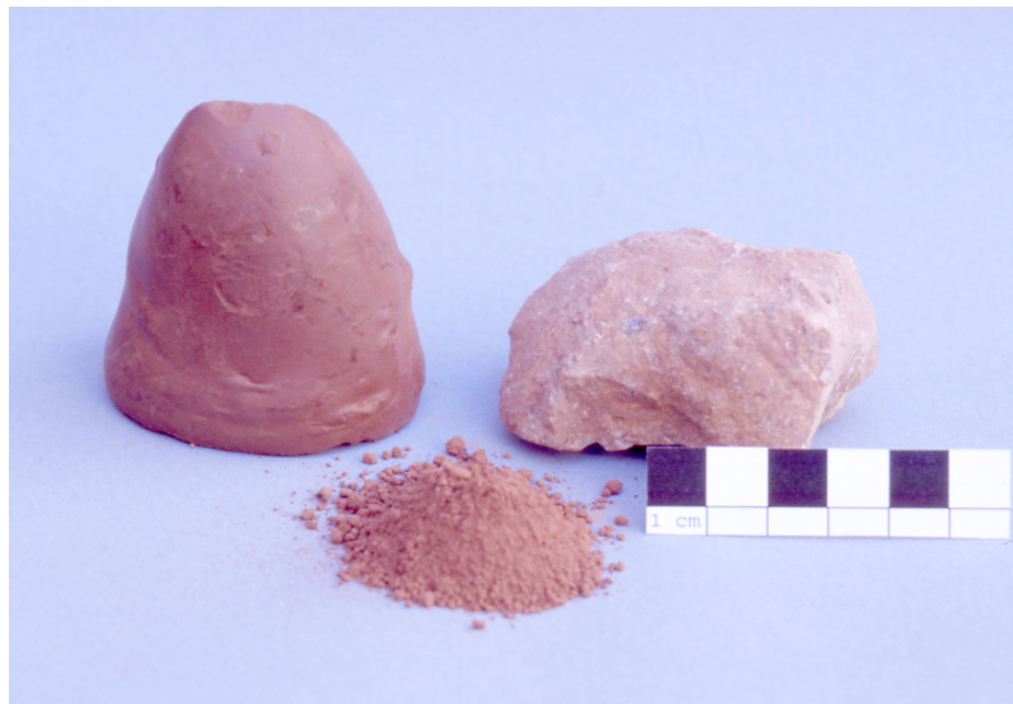
Abb. 7: Armenischer Bolus als Hütchen (hinten links), als Rohware (hinten rechts) und als Pigment (Vordergrund)
