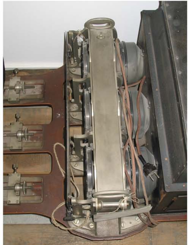
Dia-Aufnahme, Kühlkuvette, Kondensoren
