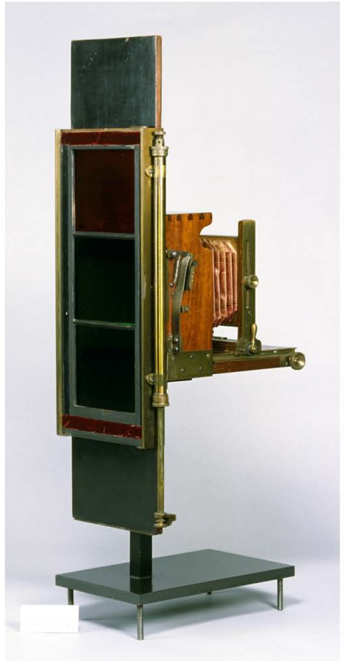
Rückansicht - Wechselschlitten ohne Plattenkassette, Lichtfilter sichtbar
