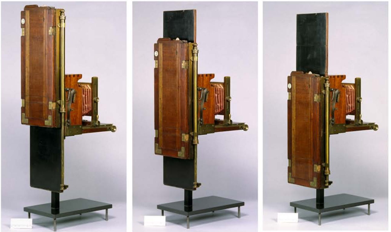
Positionen des Wechselschlittens für die Aufnahme der drei Teilbilder
