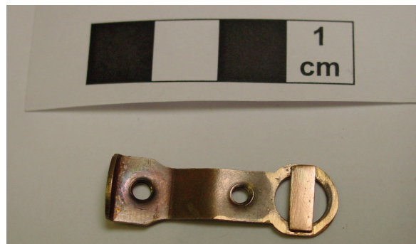
Abb. 54 Kontaktzunge der Glühlampenfassung Nach dem Auflöten des Kupferstegs
