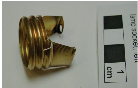
Abb. 52 Gewindehülse der Glühlampenfassung Nach dem Ausrichten, vor der Lötung
