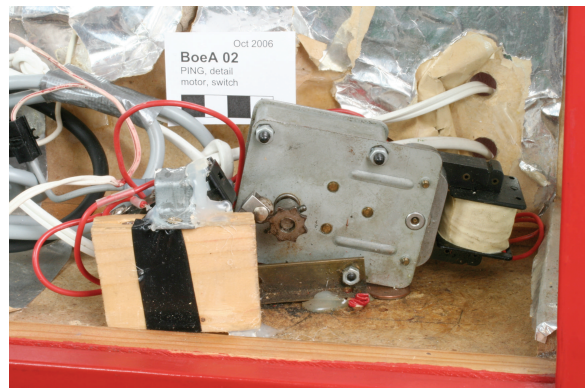
Abb. 24 PING , motorbetriebener Schaltmechanismus
