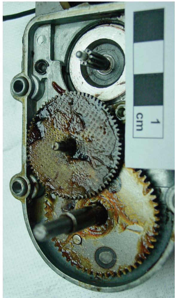
Abb. 38 Geöffnetes Getriebe des älteren Motors Von oben: Läufer, Zahnrad 2, Zahnrad 3 (Zahnrad 1 ist entnommen)
