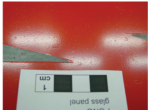
Abb. 16 PONG, Glasscheibe, Rückseite Zweite transluzente Farbschicht über den Kanten der Abdeckschicht
