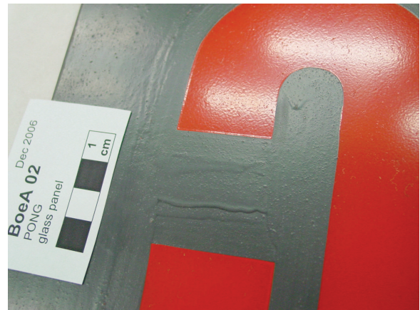
Abb. 15 PONG, Glasscheibe, Rückseite Pinselspuren der opaken Abdeckschicht
