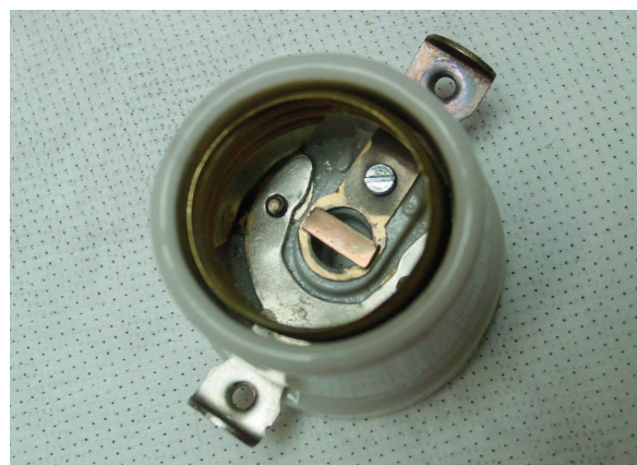
Abb. 55 Komplette Glühlampenfassung Nach der Restaurierung und Modifikation
