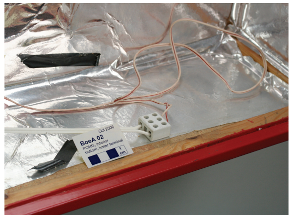
Abb. 61 PONG , Loses Kabel vor Befestigung
