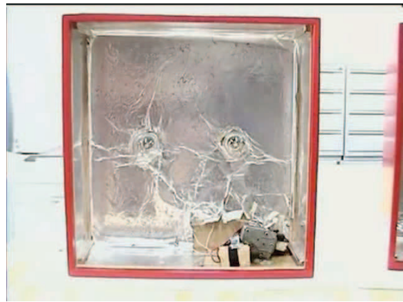
Abb. 22 PING , Korrosionserscheinungen der Aluminiumfolie im Jahr 2001 Einzelbildaufnahme aus Videofilm
