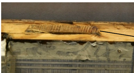
Abb. 20: Seitenteil, gegrateter Zapfen an Bruchstelle
