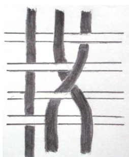
Kettfadenüberkreuzung am Übergang vom Grundgewebe zur Wirkerei
