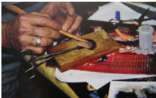
Abb. 35 Werkstatt von Paco Romero Zafrá in Córdoba/Spainien: Herstellung eines Wimpernkranzes aus Tierhaaren, hier Marderhaar (Februar 2005) [aus: FÜCKER 2006, Abb. 22].
