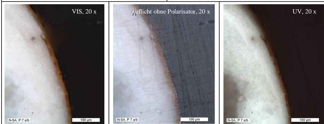
Schichtenabfolge von links nach rechts: Auf die mehrschichtige weiße Grundierung folgt eine dünne, nicht vollständig erhaltene gelb-rötliche Schicht mit Resten einer gelben Blattmetallaufgabe. Darüber befindet sich eine weiße Schicht (nur oben, nicht flächig vorhanden), eine dünne gelbe, sowie eine sehr dünne rote Schicht und eine gelbe Blattmetallaufgabe. Bei letzterer handelt es sich um die Sichtfassung (Überfassung bzw. Restaurierung).
