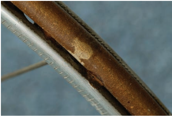
58 Weißer Gummireifen mit bräunlicher Beschichtung, mit bräunlichem Kleber stellenweise an der Felge fixiert
