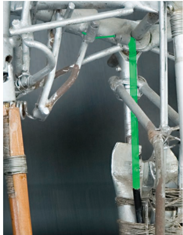
36 Grün: Angenommene Montage eines Brems- oder Einstellzuges
