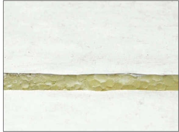
27 Tragflächen-Fuge, Styroporkern mit Beschichtung
