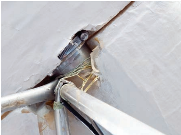
24 Befestigung der Tragflächenbolzen am Rahmen mit Schnur; getränktes Papier überdeckt Ausklinkung
