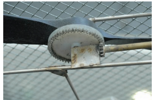
77 Getriebe aus Kunststoff- und Messingzahnrad
