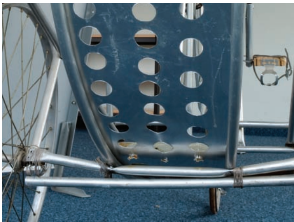
94: Rahmenstrebe ist rechts und links der Nietverbindungen mit der Sitzschale nach oben gebogen.
