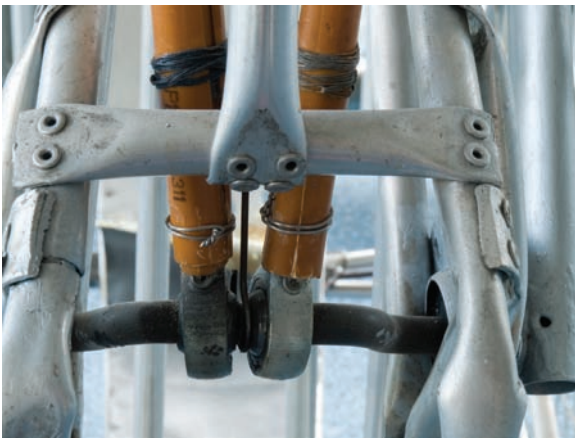
32 Kurbelwelle, kugelgelagerte Antriebsstangen
