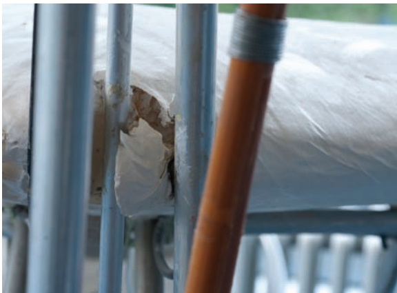
62 Abgebrochene Stück an der Tragflächenspitze
