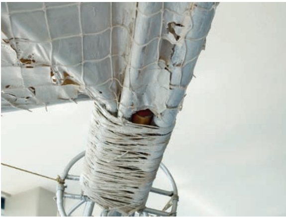
33 Fadenumwicklung am Antriebsflügelansatz
