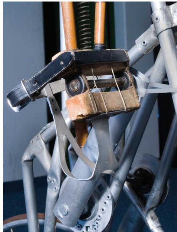
30 Pedal, Tretkurbel mit Kabelbinder fixiert und mit Tretlager, silberfarben übermalt.
