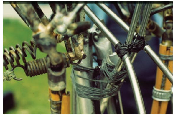
46 Brems- oder Einstellzug bereits 1977 abgetrennt
