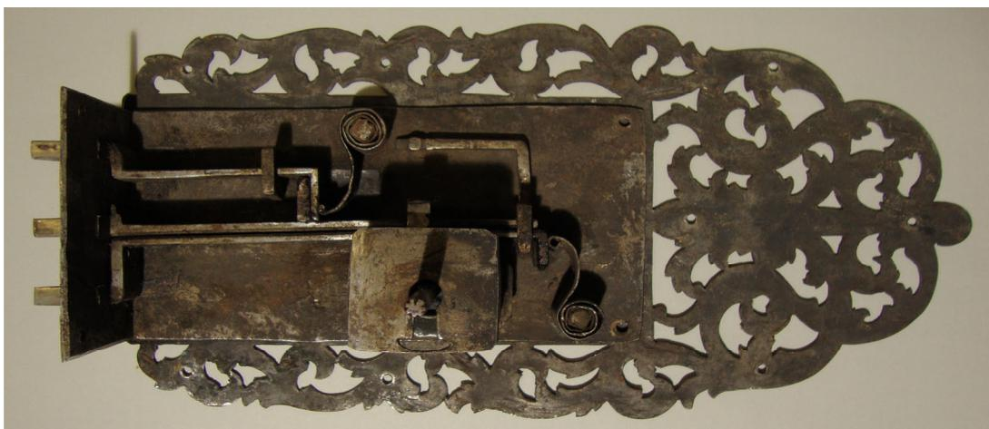
Abb. 24: Beispiel für ein Altdeutsches Einlassschloss mit polierter Schlossdecke
