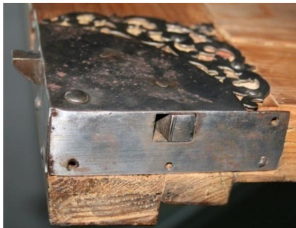
Abb. 41: Hebelriegel mit polierter Decke
