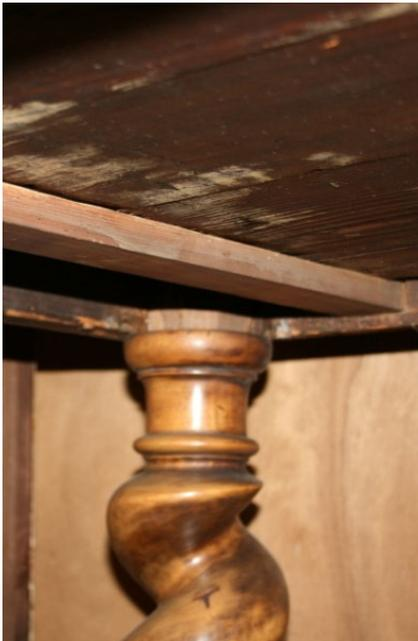
Abb. 129: Zargenkonstruktion Untergestell mit Bein, Ansicht von Unten
