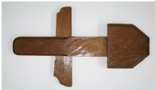
Abb. 18: Keilschließe aus Eichenholz
