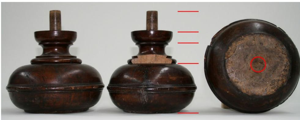
Abb. 14: gedrückte KugelfüÙe: mehrteilig, mittig mit durchgehendem Schaft aus einem Rundholz
