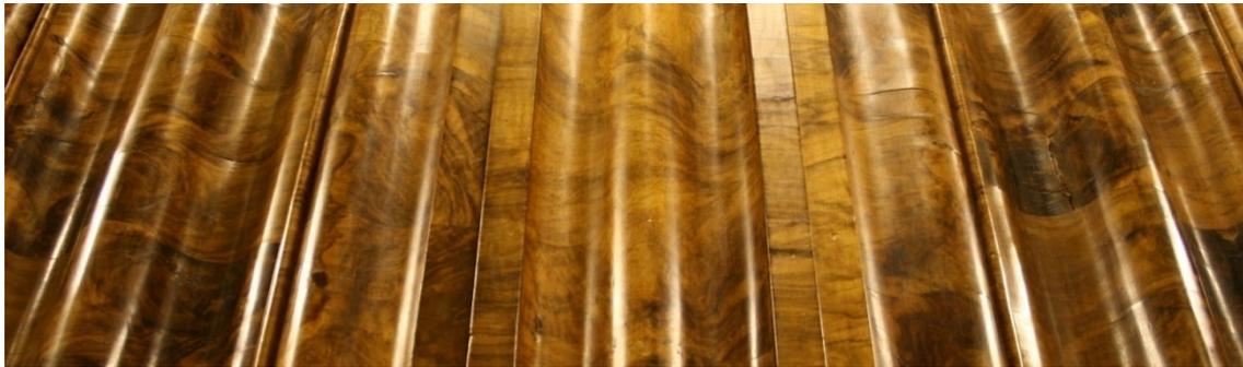
Abb. 25: Wurzelmaserfurnier: teilweise Riegelwuchs, die Wirkung wird durch Licht und Schatten in Kehle und Wulst unterstützt
