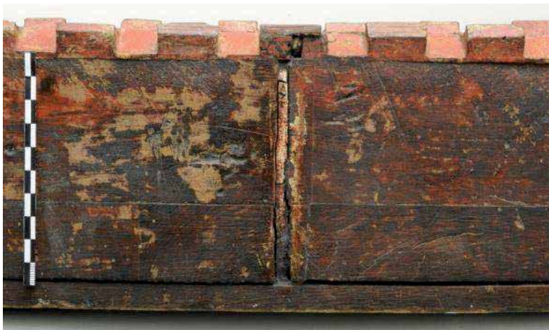
Abb. 174: Stoß der beiden Frieshälften; die durchgehende Maserung beweist, dass der Fries ursprünglich aus einem durchgehenden Brett gefertigt war.
