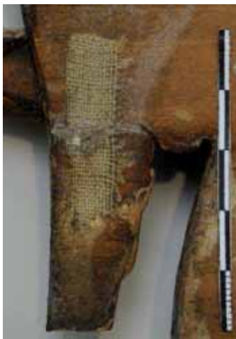
Abb. 169: Fries, RS (linke Hälfte); mit Gewebe verstärkter und verleimter Bruch einer Flügelspitze.
