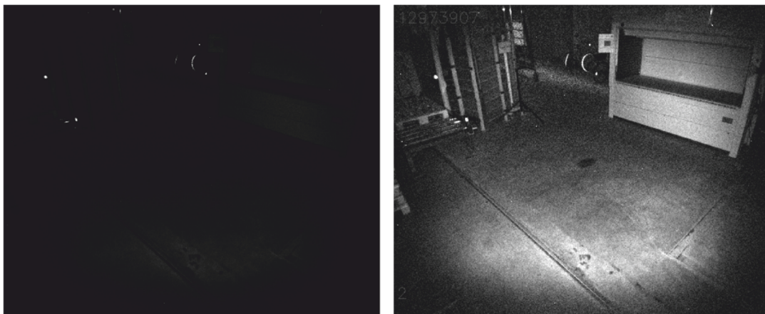
Abbildung 4-7: Umwandlung von Intensitätsbildern in den RGB-8-Bit-Bereich durch lineare Skalierung. Links: Linear konvertiertes Bild, rechts: Normalisiertes, linear konvertiertes Bild.
