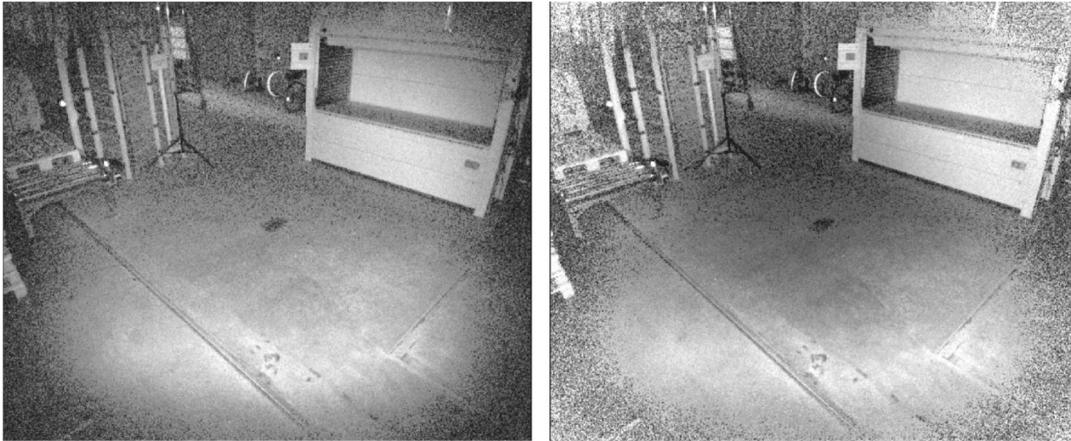
Abbildung 4-8: Links: Ergebnis der nichtlinearen Konvertierungsmethode. Rechts: Zusätzliche Entfernung der Vignetten-Abschattung.
