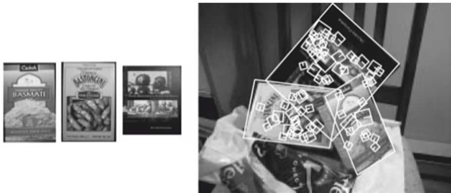
Abbildung 2-12: Beispiel für Textur-Matching mittels SIFT-Merkmalen [Low-1999].
