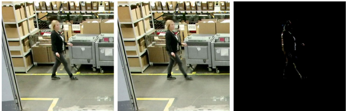
Abbildung 2-13: Differenz zweier aufeinander folgender Bilder (von links nach rechts): Bild 1, Bild 2, Differenzbild.
