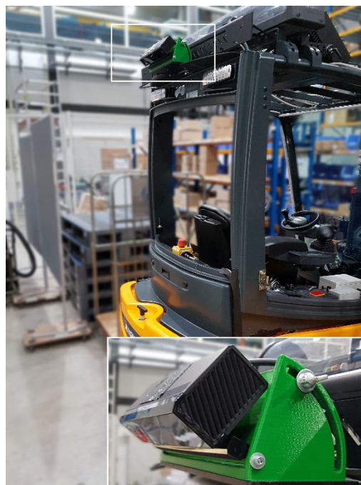
Abbildung 4-1: Beispielhafte Befestigung des Sensors an einem Gegengewichtsstapler.
