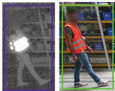
Abbildung 6-20: Bildstörung durch Sicherheitsweste. Links: Intensitätsbild, rechts: Farbbild.
