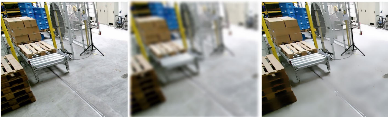
Abbildung 2-9: Beispiele für Weichzeichnen. (links nach rechts): Originalbild, Gaußsches Weichzeichnen, Weichzeichnen mit bilateralem Filter.
