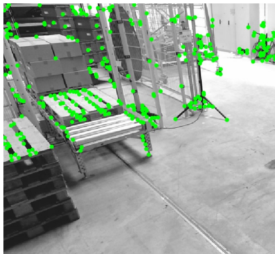
Abbildung 2-11: Beispiel für Eckpunkte mittels Harris-Detektor [Har-1988].
