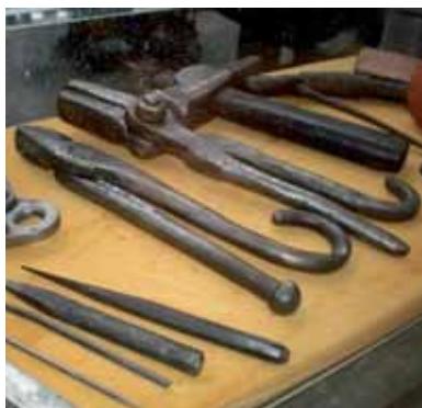
Abb. 8 (li.): Drahtzieheisen und Drahtmaße, ausgestellt im GNM
