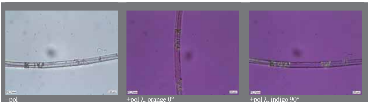
Abb. 301: Faserpräparat P2 (Fadenseele, Klöppelspitze), Bestimmung nach dem HERZOG-Test.
