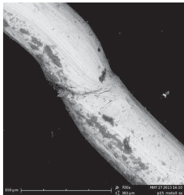
Abb. 528: P15_Metall; Oberflächenunvollkommenheiten in Form von Brüchen, Riefen, Streifen, Überlappungen, Kerbschnitten, Kratzern und Ablagerungen
