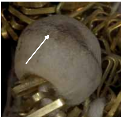
Abb. 307: ausgeprägter Grat von der Bearbeitung auf der Drehbank
