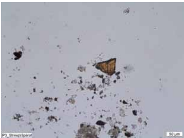
Abb. 296: Streupräparat P3 der roten Fassung Ergebnis: Mennige, Auripigment, roter Farblack, Eisen, Calcit
