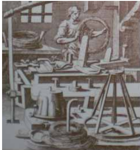
Abb. 12 (li.): Messingdraht- Scheibenzieher, Kupferstich um 1550
