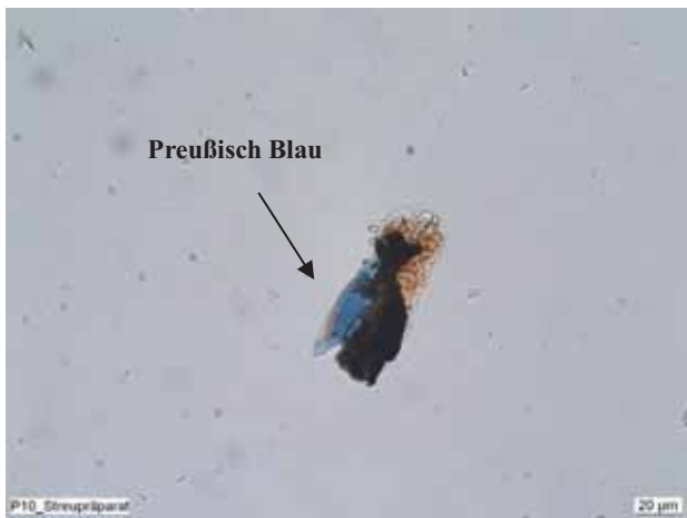
Abb. 72: Streupräparat P10 des blauen Lüsters auf einem Cabochonimitat Ergebnis: Preußisch Blau, Gips, Poliment, Calcit
