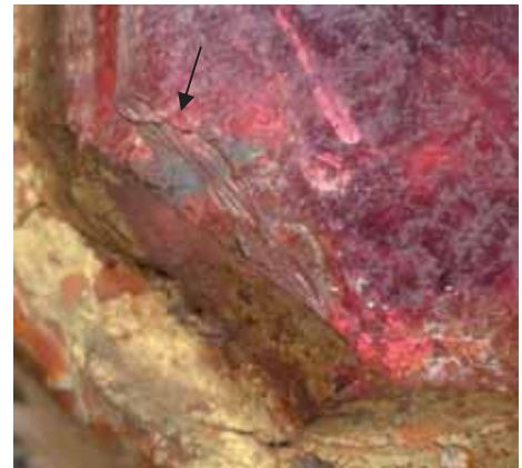
Abb. 79: beschädigte Dublette, muscheliger Bruch der Kante
