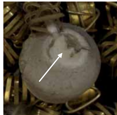
Abb. 309: halb verschlossenes, kleines Bohrloch ohne Beschichtung
