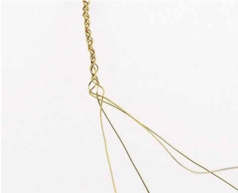
Abb. 486 (li): „Drahtkettchen“ während der Herstellung
