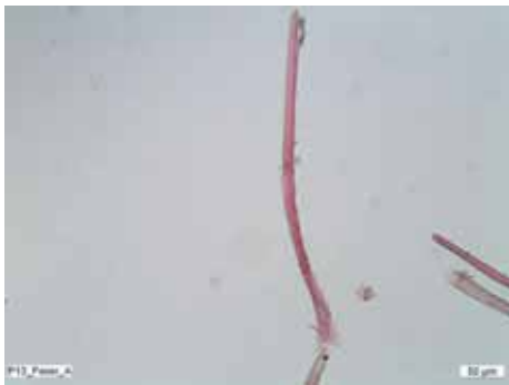
Abb. 80: Faserpräparat P13 (Damast), –pol; rot gefärbte Seide
