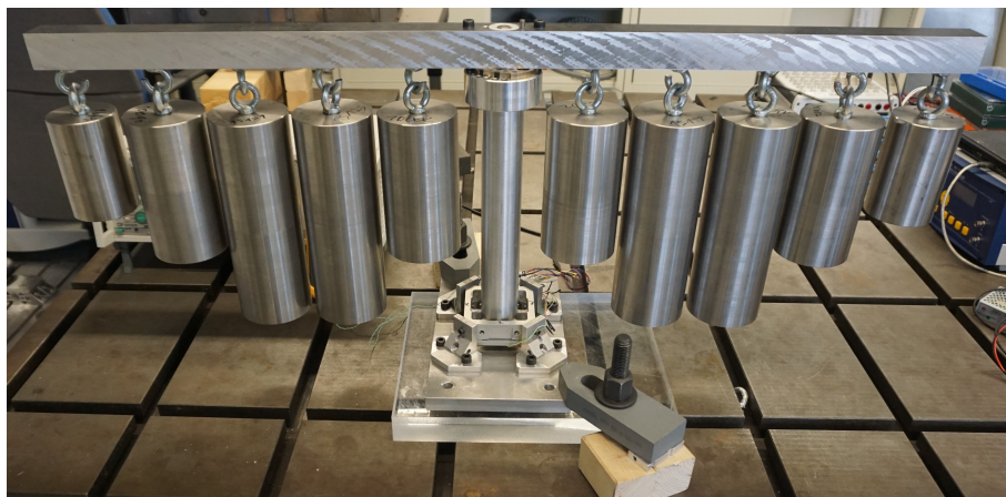
Abbildung 4.7: Versuchsaufbau zur Kraftmessung mit Maximallast (1158 N).
