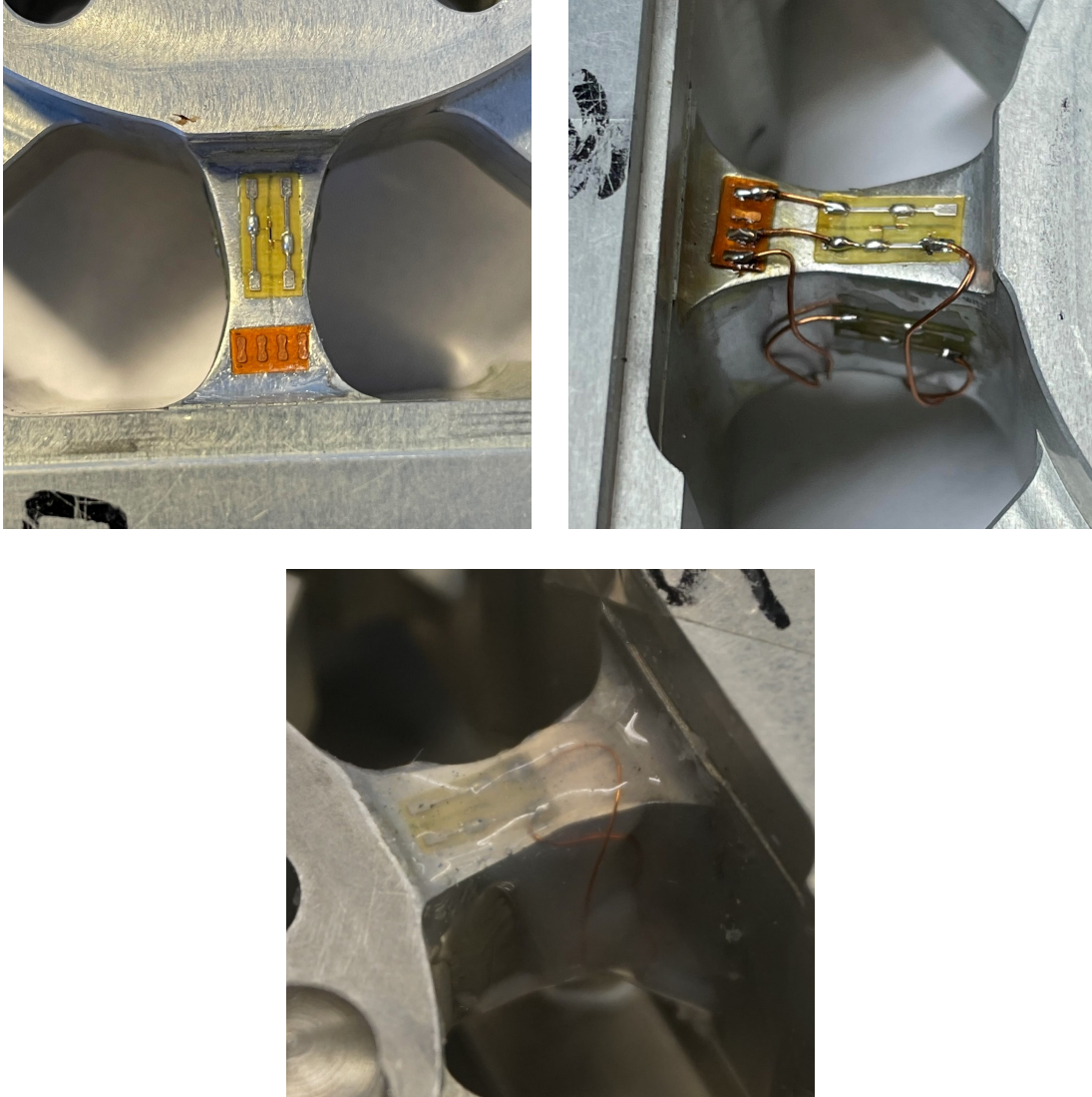
Abbildung A.5: Anbringen des Lötstützpunkts (oben links), Bildung der Messbrücken (oben rechts) und versiegelte Messbrücken (unten).
