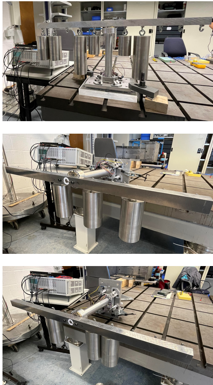
Abbildung 6.4: Konfiguration mit vertikalem Mast (oben) und mit horizontalem Mast (mittig und unten) zur Kalibriermessung.
