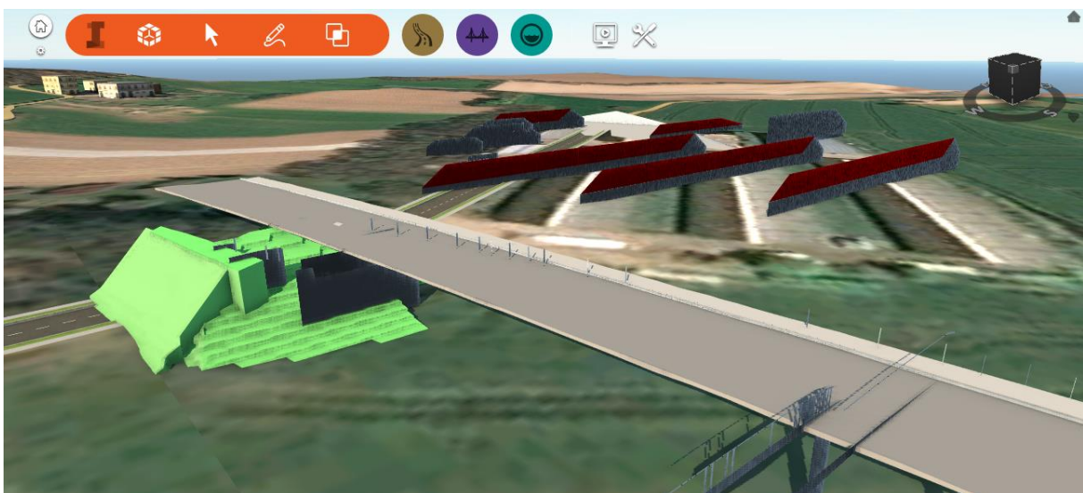
Abbildung 31: Fehlerhafte Platzierung der Objekte in InfraWorks
