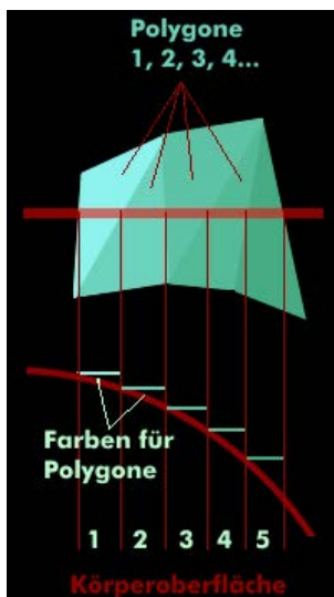
Abbildung 12: Flat-Shading (Quelle: ITWissen, 2013)
