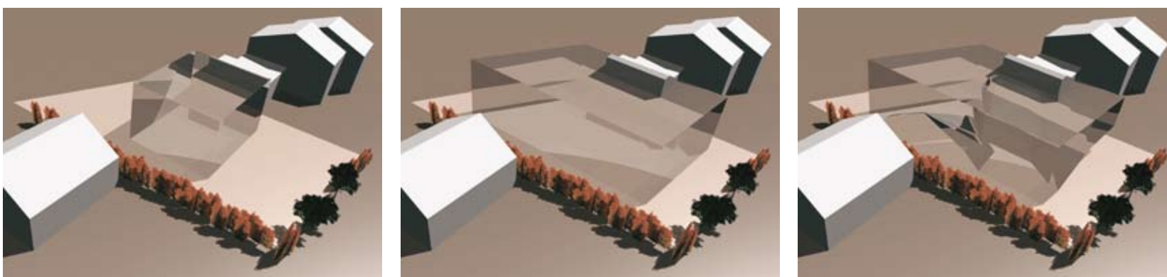
Maximal zulässiges Volumen nach GFZ und GRZ = 634,48 m 3
