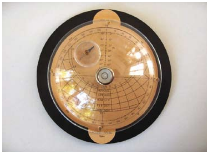
Horizontoskop und Sonnenstandsdiagramm. Foto: 2009 Institut für Tageslichttechnik, Stuttgart
