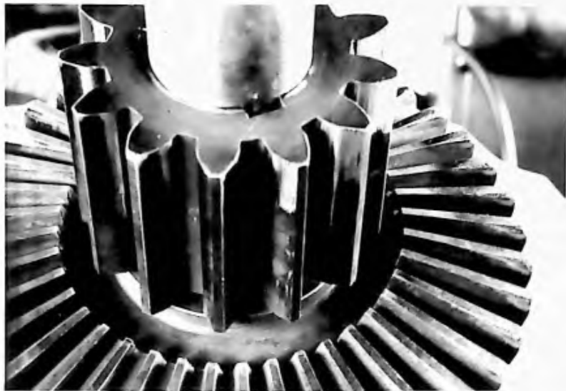
Die Keilbefestigung des Kegelrades auf der Vorgelegewelle.
