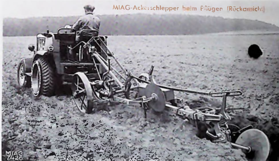
LD-Schlepper mit Eisengreiferrädern
