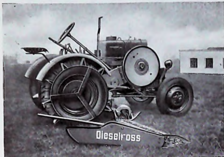
Dieselroß F 18 mit elektrischer Beleuchtung und Zusatzgreifer
