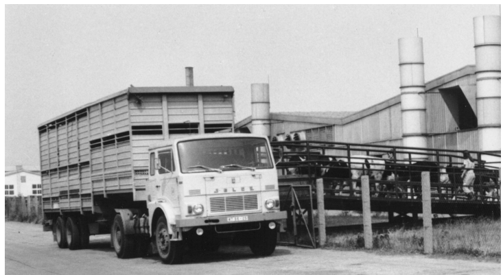
Bild 8: Universal-Tiertransportauflieger bei der Beladung mit Mastbullen an der Tierproduktionsanlage
