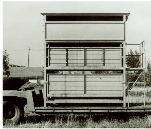
Bild 2: Experimentier-3-Etagenzone für praktische Testverladungen und –transporte (1974)
