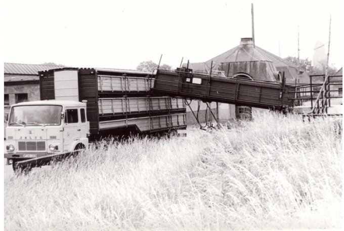
Bild 7: Einsatz des Spezial-Schweinetransportaufliegers HLS 180.88 bei der Anlieferung im Schlachthof Dresden
