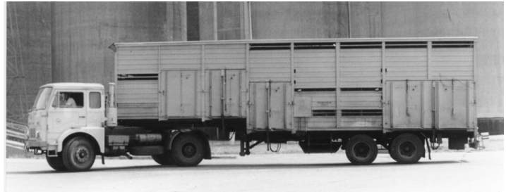
Bild 4: Universal-Tiertransportauflieger HLS 170.88 mit Sattelzugmaschine Jelcz
