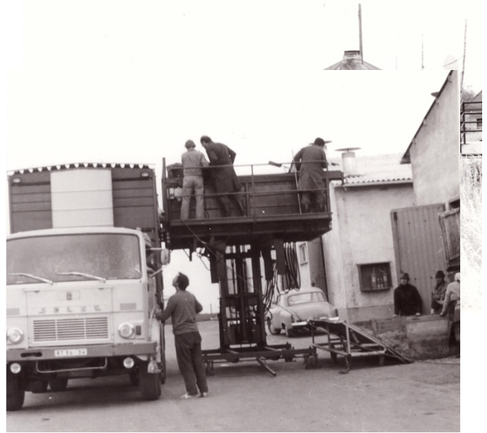
Bild 5: Spezial-Schweinetransportauflieger HLS 180.88 mit Hubbühne am Gabelstapler DFG 6302 (1975)
