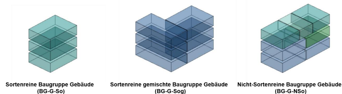
Abbildung 19 Übersicht der drei Varianten von Baugruppen-Gebäude (BG-G)
