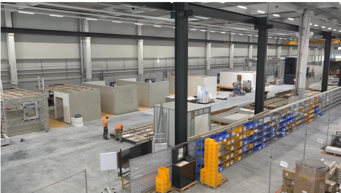
Abbildung 39 Produktionsstraße ‚maxmodul‘ auf dem Firmengelände von Max Bögl
