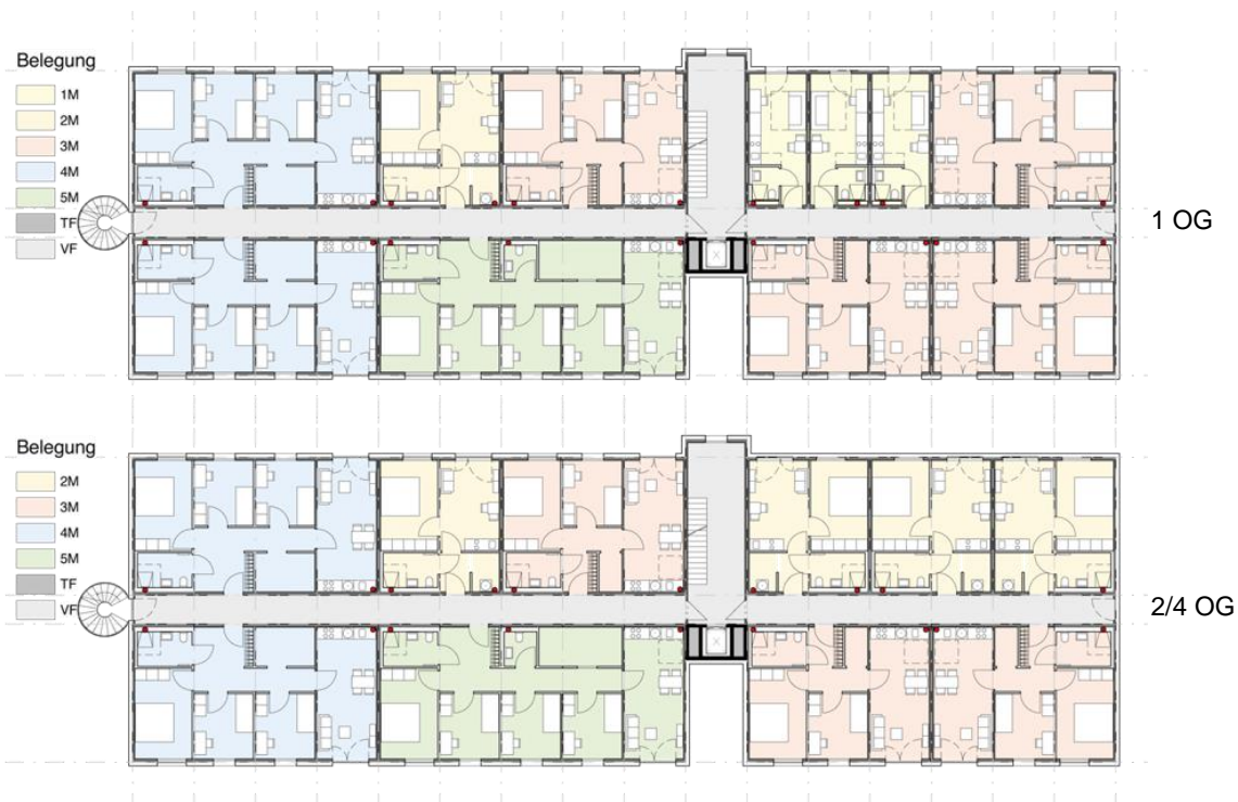
Abbildung 84 Referenzgebäude Suffizienz V2, Grundrisse 1, 2 und 4 OG
