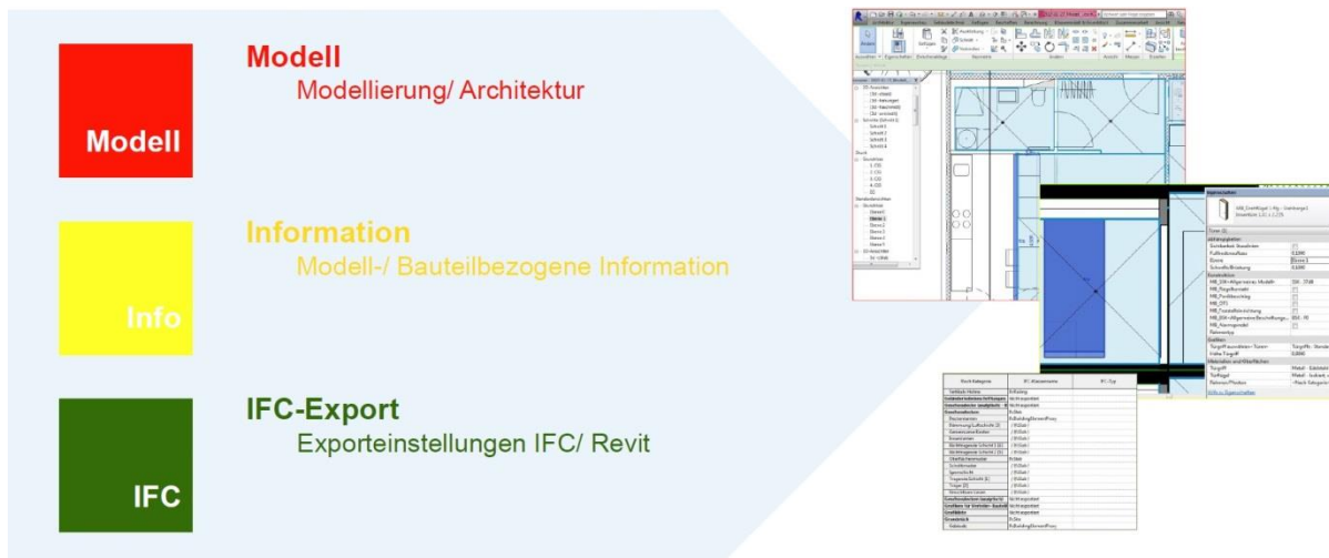
Abbildung 159 Output: Anforderungen an ein BIM-Modell in Autodesk Revit für Regelprüfungen mit SMC, Handlungsempfehlungen
