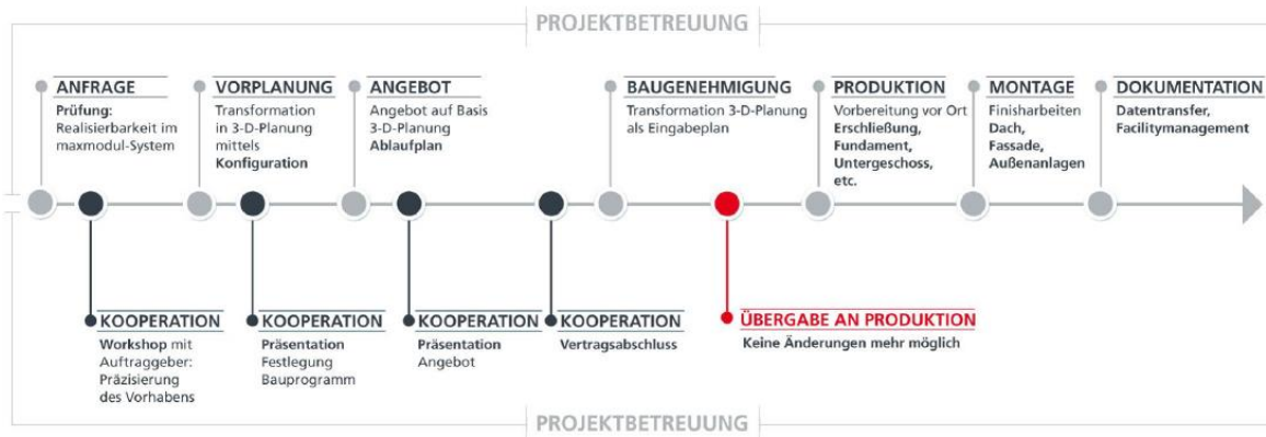
Abbildung 166 Der skizzierte Prozess eines Bauvorhabens mit Raummodulen
