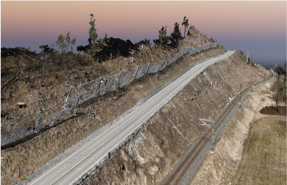
Abb. 74: Photogrammetrische Geländeaufnahme im Bereich der B 20 am Eisenrichterberg (Gebauer 2018)
