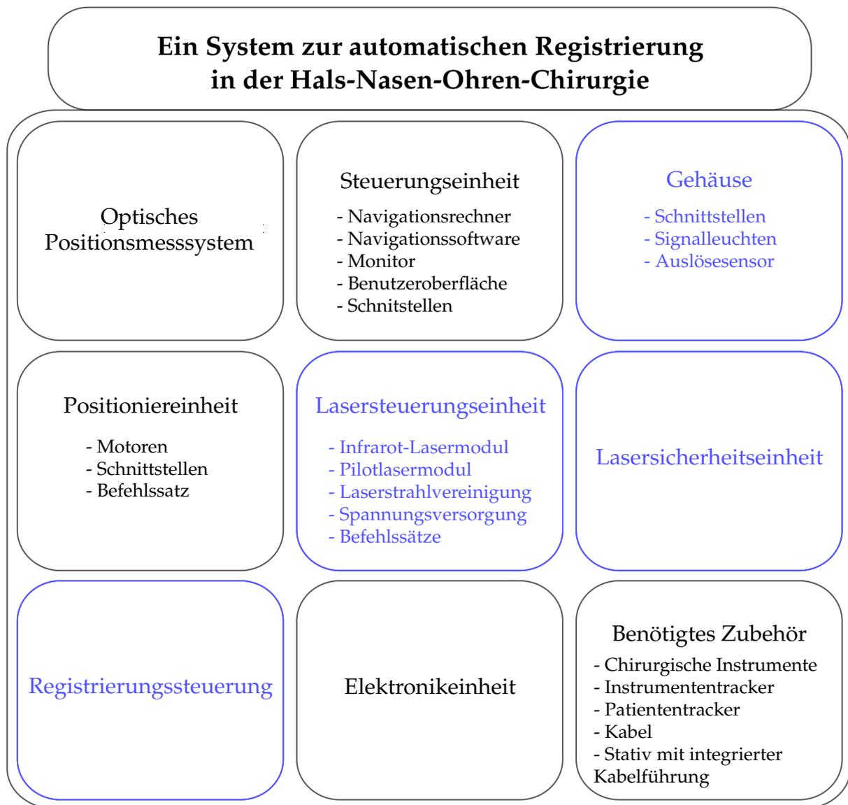
**Abbildung 7.2:** Übersicht aller Komponenten des Gesamtsystems zur automatischen Registrierung für die Hals-Nasen-Ohren-Chirurgie. Die in dieser Arbeit realisierten Komponenten *Gehäuse*, *Lasersteuerungseinheit*, *Lasersicherheitseinheit* und *Registrierungssteuerung* sind in Blau eingefärbt.
