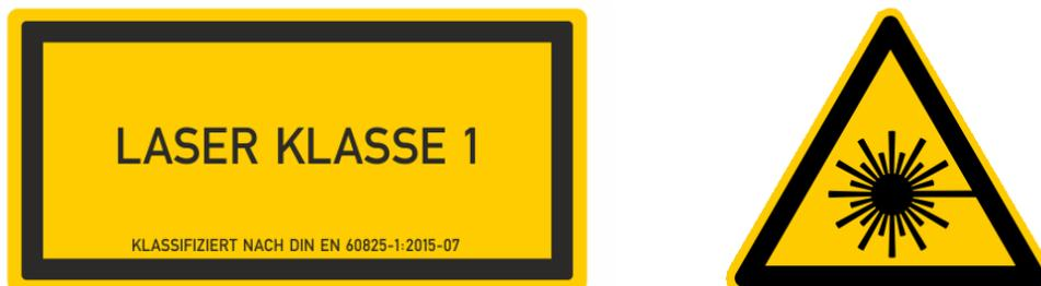
**Abbildung 5.2:** Hinweisschilder für Lasereinrichtungen der Klasse 1 nach DIN EN 60825-1:2015-07.
