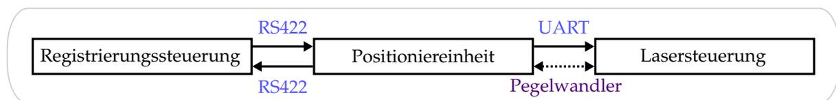
**Abbildung 7.9:** Digitale Schnittstellen in dem Modul Automatische Registrierung. Die Kommunikation erfolgt zwischen der Registrierungssteuerung, der Positioniereinheit und der Lasersteuerung.
