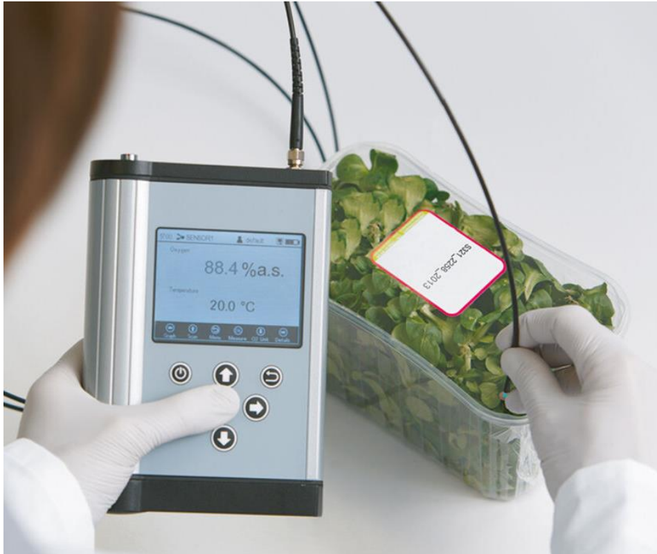
Abbildung 2.11: Beispielhafte Anwendung des Sauerstoffmessgeräts „Fibox 4“ zur Analyse der Sauerstoffkonzentration in einer Lebensmittelverpackung (PreSens Precision Sensing GmbH)
