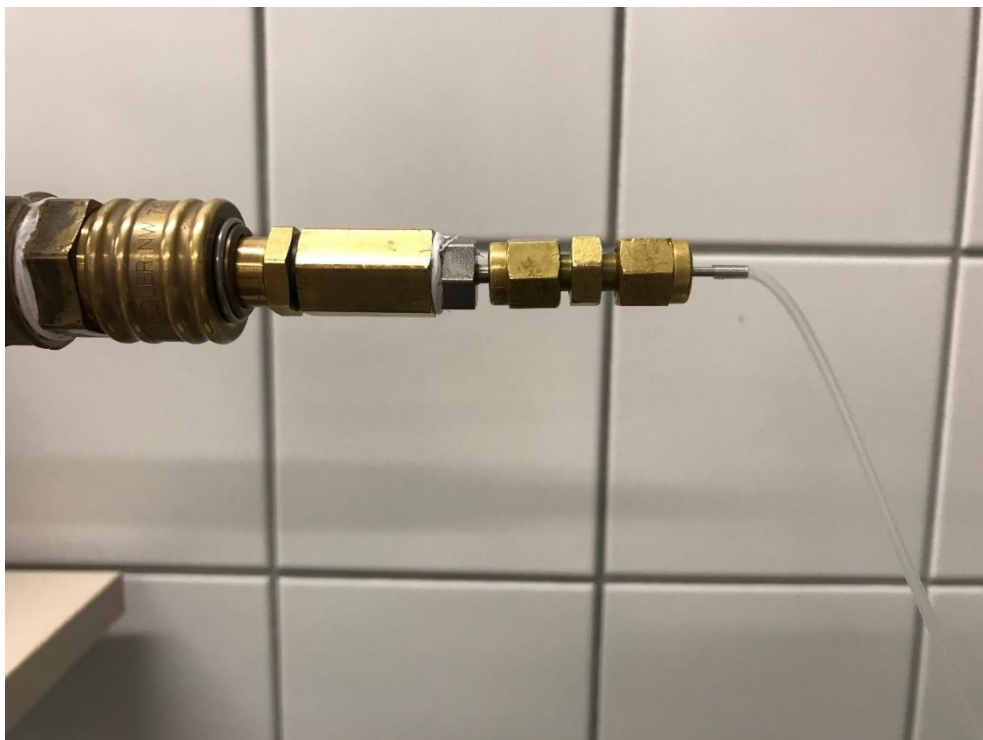
Abbildung 3.7: Anschluss an Gasmischer, Verbindung mit dünnem Schlauch zwischen Messzelle und Gasmischer
