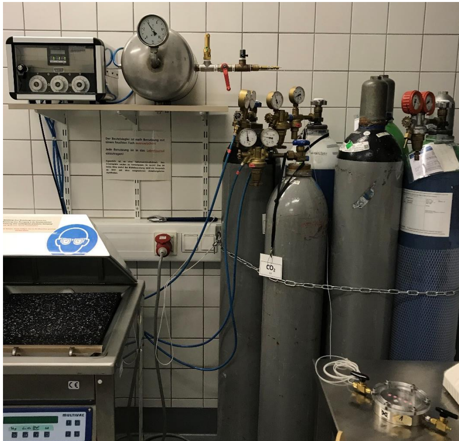
Abbildung 3.6: Anschluss der Messzelle an Gasmischer mit dünnem Schlauch und manuell eingestellte, geringe Strömungsgeschwindigkeit zur Spülung der Messzelle
