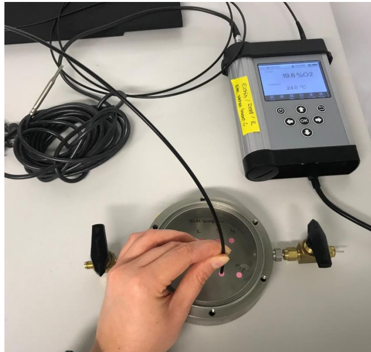
Abbildung 3.5: Messung des Sauerstoffgehalts mit dem Sauerstoffmessgerät der Firma PreSens Precision Sensing GmbH durch eine Glasscheibe
